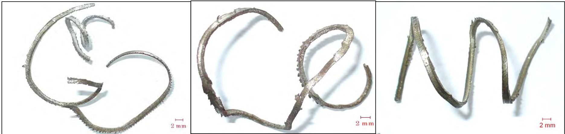
รูปที่ 3.8 เศษกึ่งที่ความลึกตัด 0.42 mm จากมีดกึ่ง a) R_a = 1.55 \mu m b) R_a = 0.25 \mu m c) R_a = 0.06 \mu m
