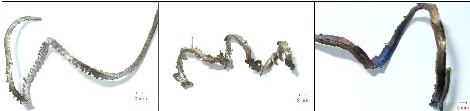
รูปที่ 3.11 เศษกลิ้งที่ความลึกตัด 0.74 mm จากมีดกลิ้ง a) R_a = 1.55 \mu m b) R_a = 0.25 \mu m c) R_a = 0.06 \mu m
