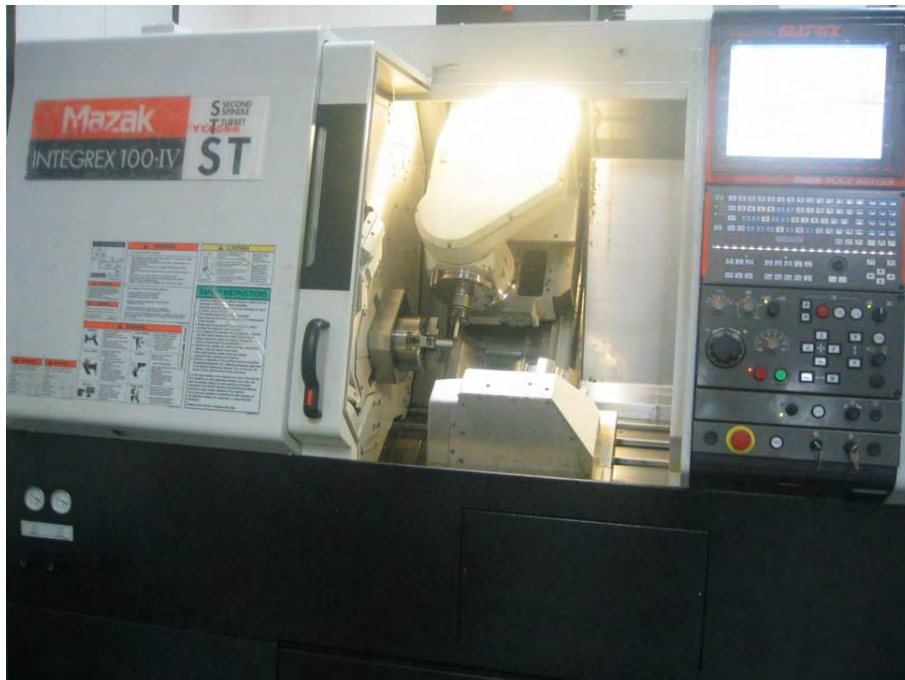
รูปที่ 4.4 มีดกลึงแบบโรตารีที่ติดอยู่กับเครื่อง Lathe multitasking CNC
