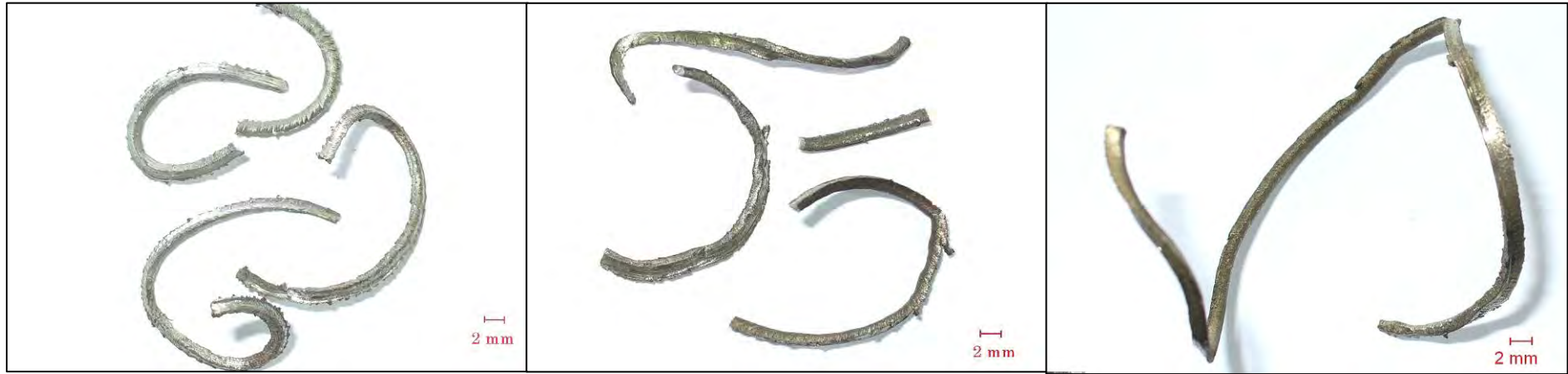
รูปที่ 3.9 เศษกลิ้งที่ความลึกตัด 0.54 mm จากมีดกลิ้ง a) R_a = 1.55 \mu m b) R_a = 0.25 \mu m c) R_a = 0.06 \mu m
