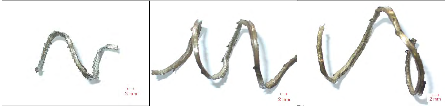
รูปที่ 3.11 เศษกลิ้งที่ความลึกตัด 0.74 mm จากมีดกลิ้ง a) R_a = 1.55 \mu m b) R_a = 0.25 \mu m c) R_a = 0.06 \mu m
