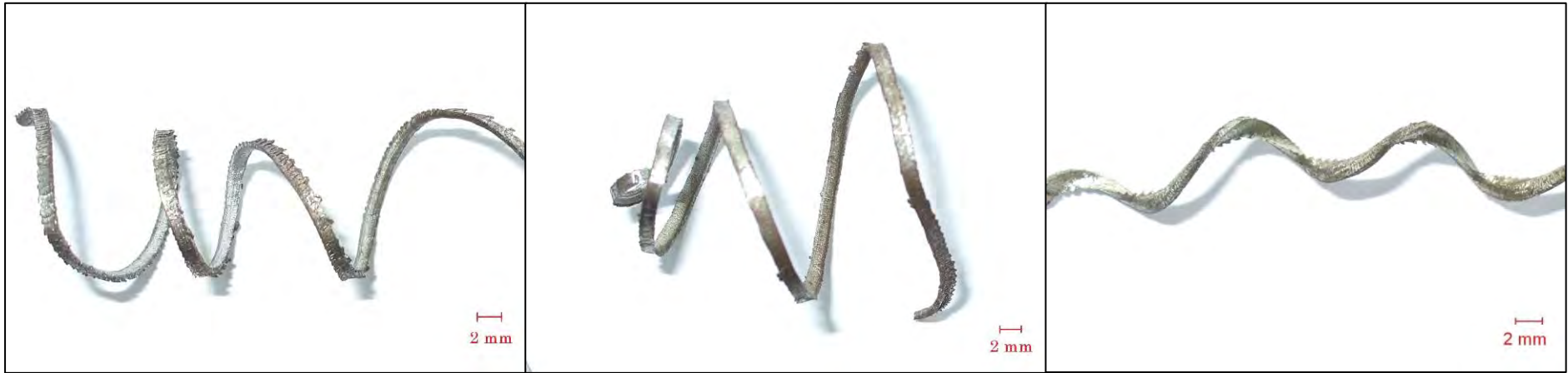
รูปที่ 3.7 เศษกึ่งที่ความลึกตัด 0.30 mm จากมีดกึ่ง a) R_a = 1.55 \mu m b) R_a = 0.25 \mu m c) R_a = 0.06 \mu m
