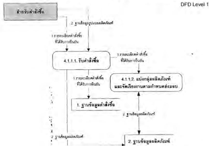
รูปที่ 25 Data Flow Diagram Level 1 การรับคำสั่งซื้อ และประมวลข้อมูลเบื้องต้น
