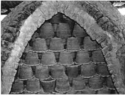
รูปที่ 1.1 การเรียงผลิตภัณฑ์ภายในเตาเผาและการขึ้นรูป ของโรงงานเครื่องปั้นดินเผา ตำบลหูกวาง อำเภอบรรพตพิสัย จังหวัดนครสวรรค์ 2553
