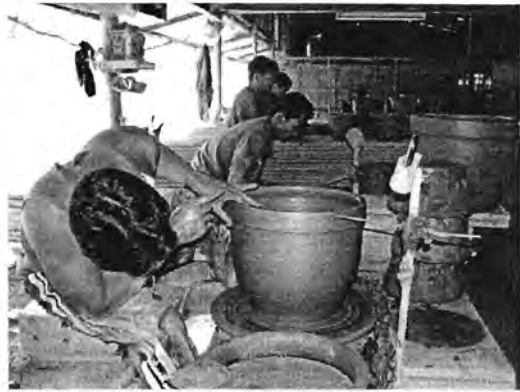
รูปที่ 1.1 การเรียงผลิตภัณฑ์ภายในเตาเผาและการขึ้นรูป ของโรงงานเครื่องปั้นดินเผา ตำบลหูกวาง อำเภอบรรพตพิสัย จังหวัดนครสวรรค์ 2553
