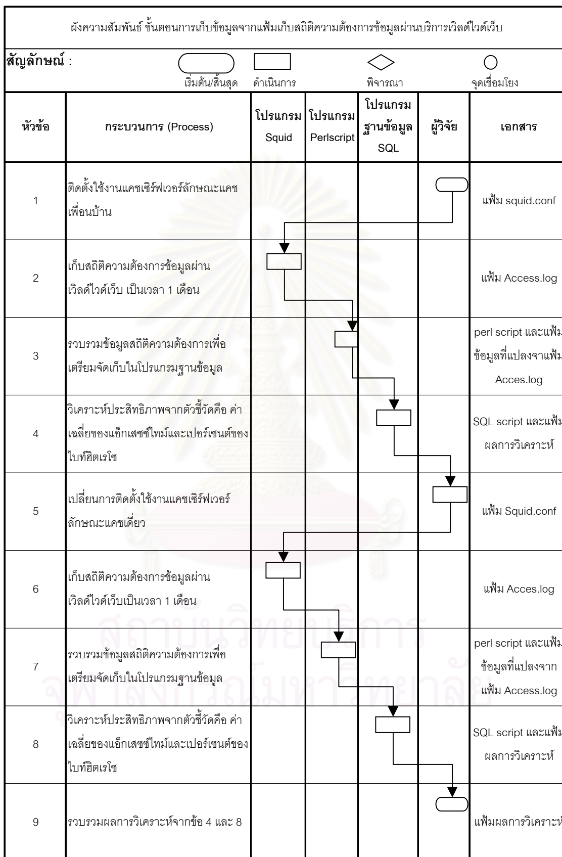
ตารางที่ 4.1 แสดงผังความสัมพันธ์ขั้นตอนการเก็บ รวบรวม และเตรียมสถิติการความต้องการข้อมูล
