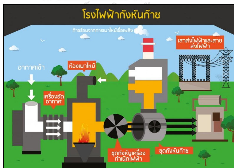
รูปที่ 2. 5 แสดงแผนผังการทำงานของโรงไฟฟ้ากังหันก๊าซ
