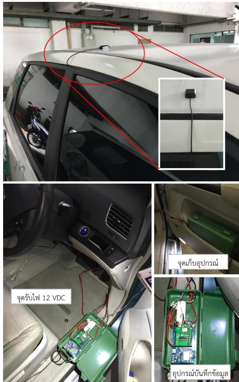
รูปที่ 15 การติดตั้ง GPS และอุปกรณ์เก็บข้อมูล
