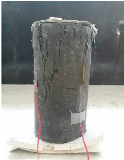
(ก) การทดสอบกำลังการรับแรงอัด
