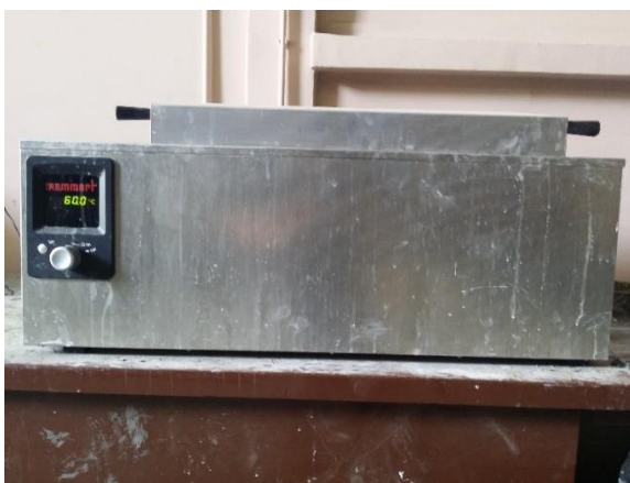
รูปที่ 4.5 การบ่มร้อนอุณหภูมิ 60 องศาเซลเซียส
