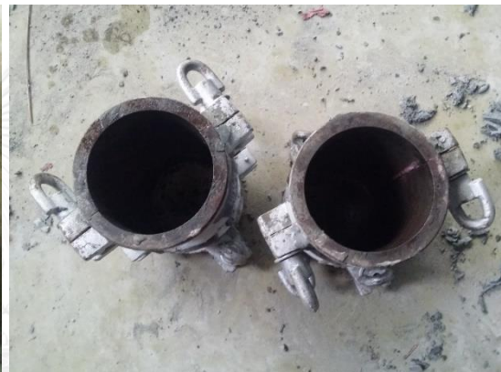
(ง) แบบหล่อตัวอย่างทดสอบแรงอัด
