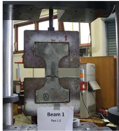
(ข) การทดสอบกำลังการรับแรงดึง
