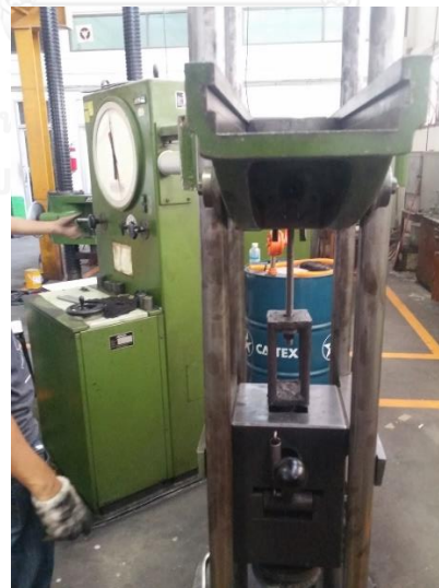
รูปที่ 4.8 การทดสอบสลักเกลียวและแป้นเกลียว
