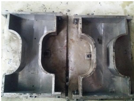
(ค) แบบหล่อตัวอย่างทดสอบแรงดึง
