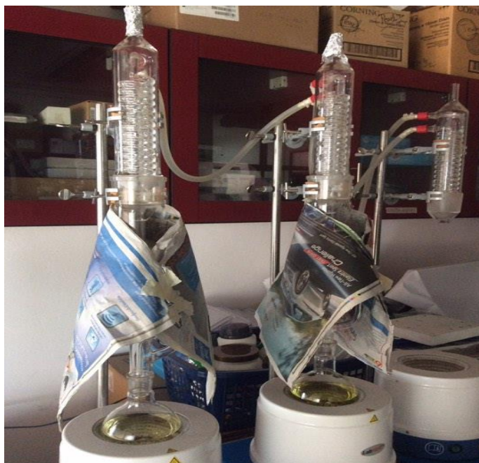
ภาพที่ 13 เครื่อง Soxhlet extractor ซึ่งเป็นการสกัดแบบต่อเนื่อง โดยให้ความร้อนแก่ตัวทำละลาย เมื่อถึงจุดเดือดจะเกิดการระเหย แล้วไปควบแน่นบริเวณ Condenser เป็นหยดน้ำตกลงมาใน Thimbles ซึ่งบรรจุสมุนไพรมันที่บดแล้ว โดยเกิดการสกัดแบบต่อเนื่องจนการสกัดเสร็จสมบูรณ์
