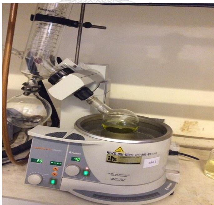
ภาพที่ 14 เครื่อง Evaporator เป็นเครื่องที่ใช้ในการระเหยตัวทำละลายออกจากสารสกัด โดยให้ความร้อนกับสารที่สกัดได้จากเครื่อง Soxhlet extractor สุดท้ายได้สารสกัดหยาบที่เข้มข้น
