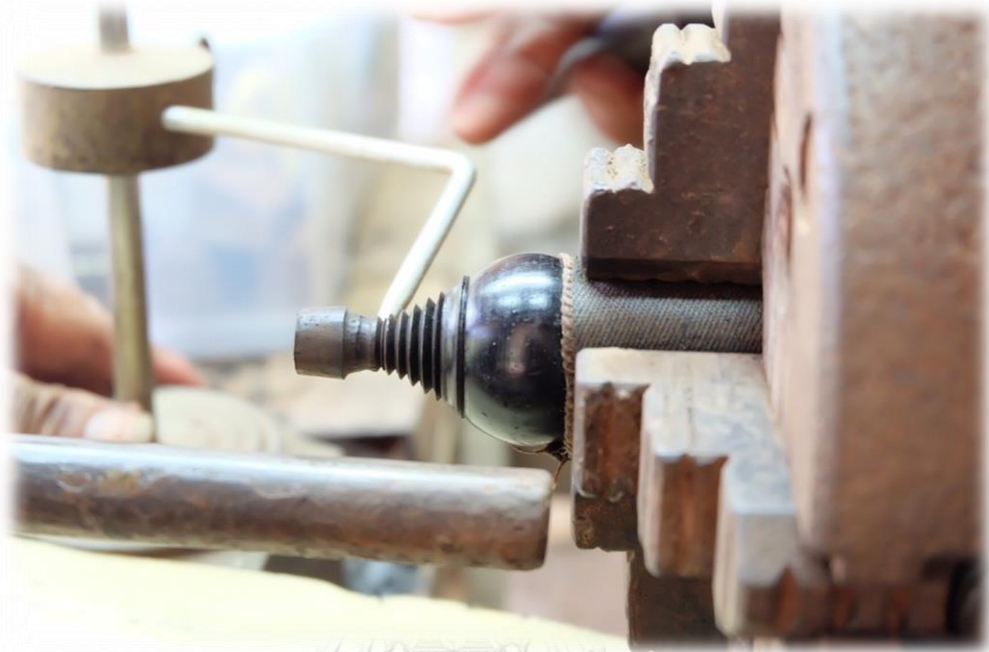
ภาพที่ 163 นำลูกบิดเข้าเครื่องกลึง
