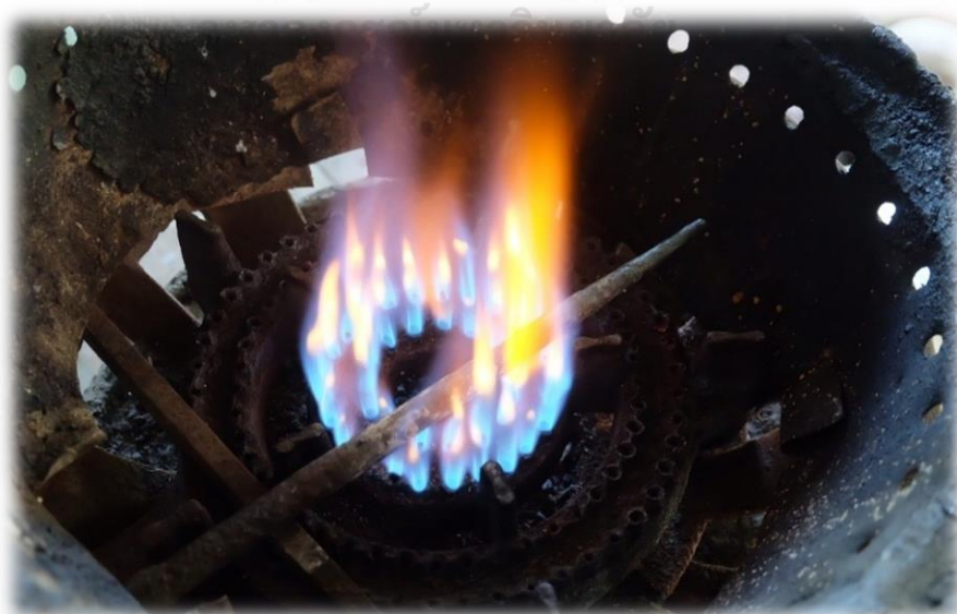
ภาพที่ 126 นำเหล็กคว้านขยายรูเผาไฟ
