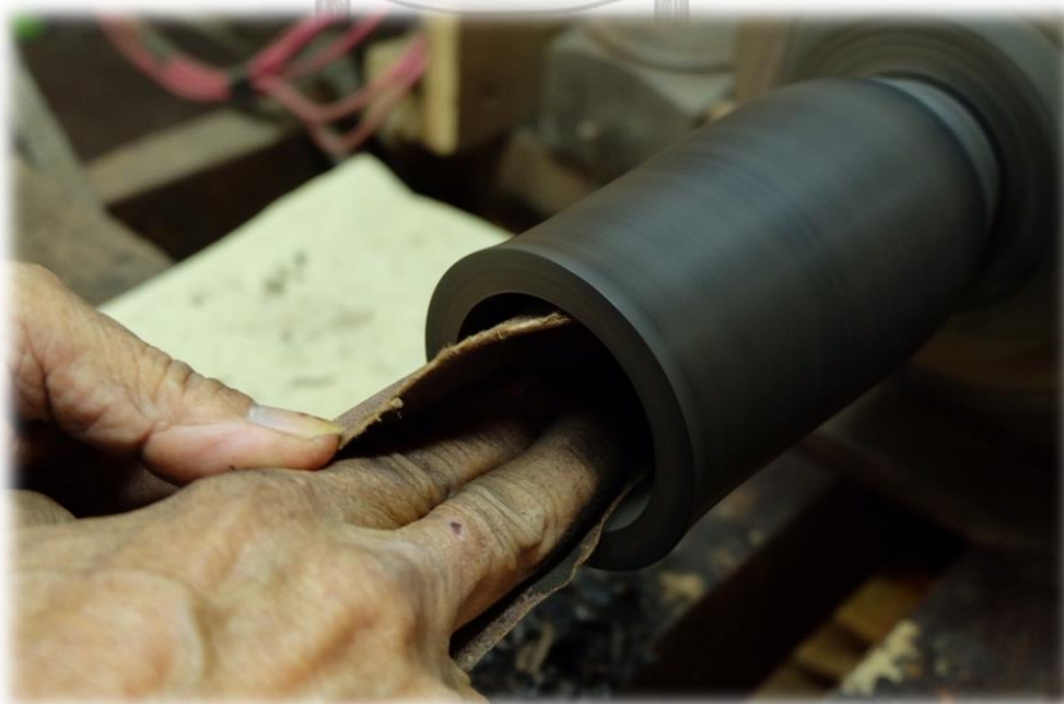
ภาพที่ 120 นำกระดาษทรายบดขัดด้านในเพื่อลบรอยมีดกลึง
