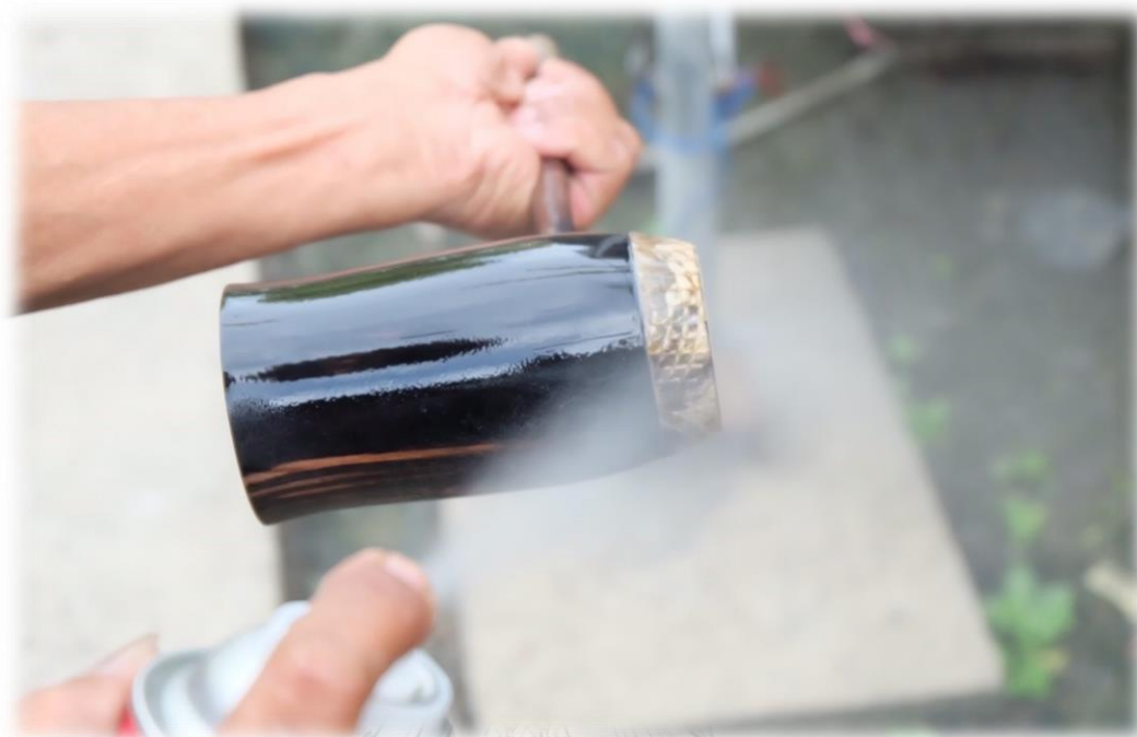
ภาพที่ 152 ฉีดพ่นแล็กเกอร์ลงบนกระบอกขอด้วง
