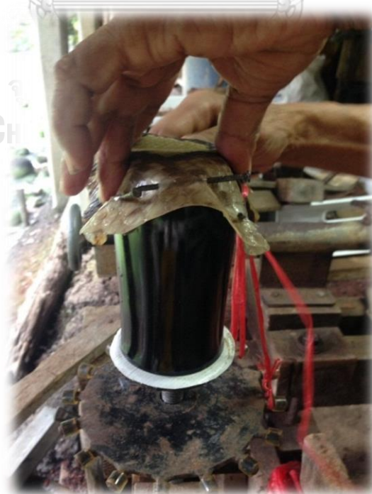
ภาพที่ 138 เตรียมขึ้นหนังหน้าซอ
