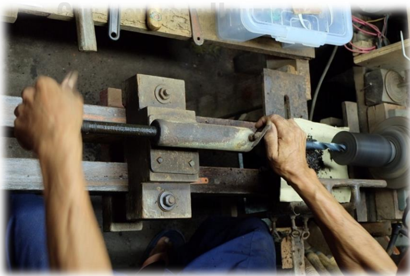
ภาพที่ 116 เจาะปากกระบอกซอ
