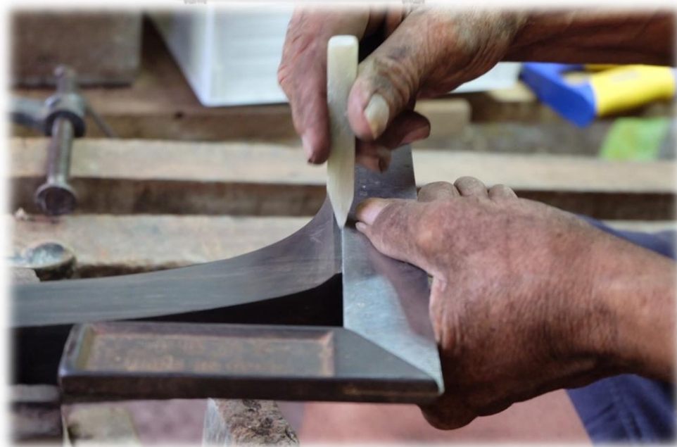
ภาพที่ 230 วัดสัดส่วนเพื่อสร้างคิ้วบริเวณโขน
