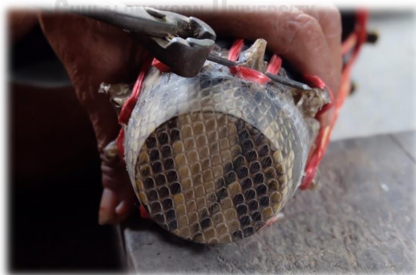
ภาพที่ 143 ถอดตะปูออกจากหนังสือไว้
