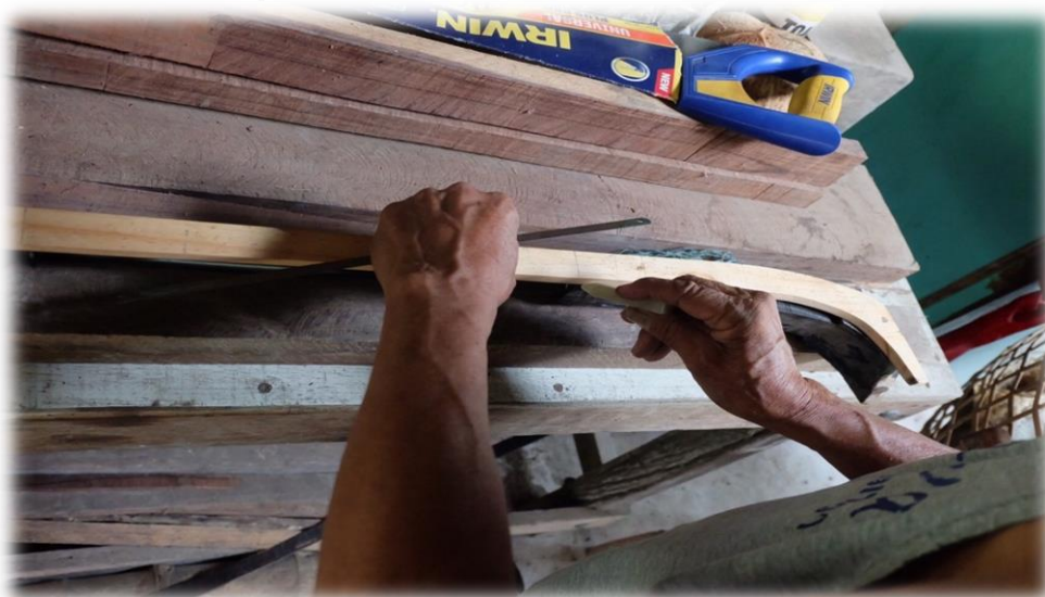
ภาพที่ 216 วัดตัดส่วนโขนซอด้วง
