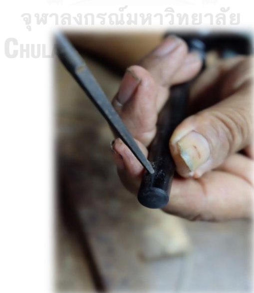
ภาพที่ 168 ใช้เหล็กหมาดขยายรูสำหรับร้อยสาย
