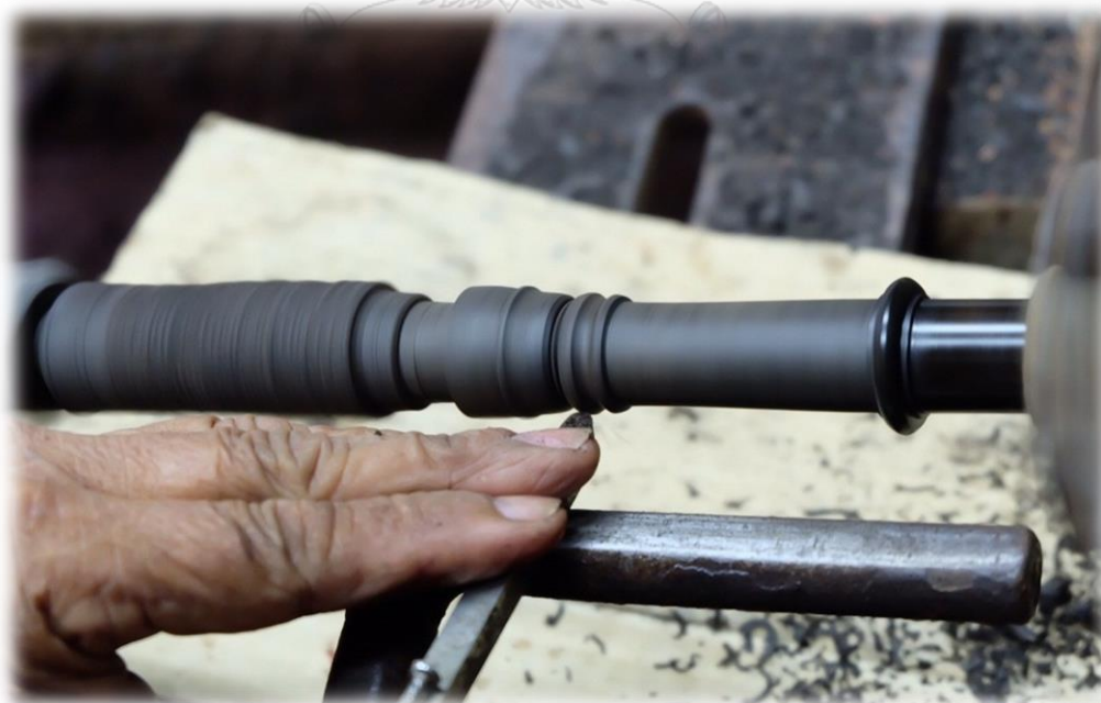
ภาพที่ 214 ใช้มีดกลึงค้อม้ากลึงสร้างลวดลาย
