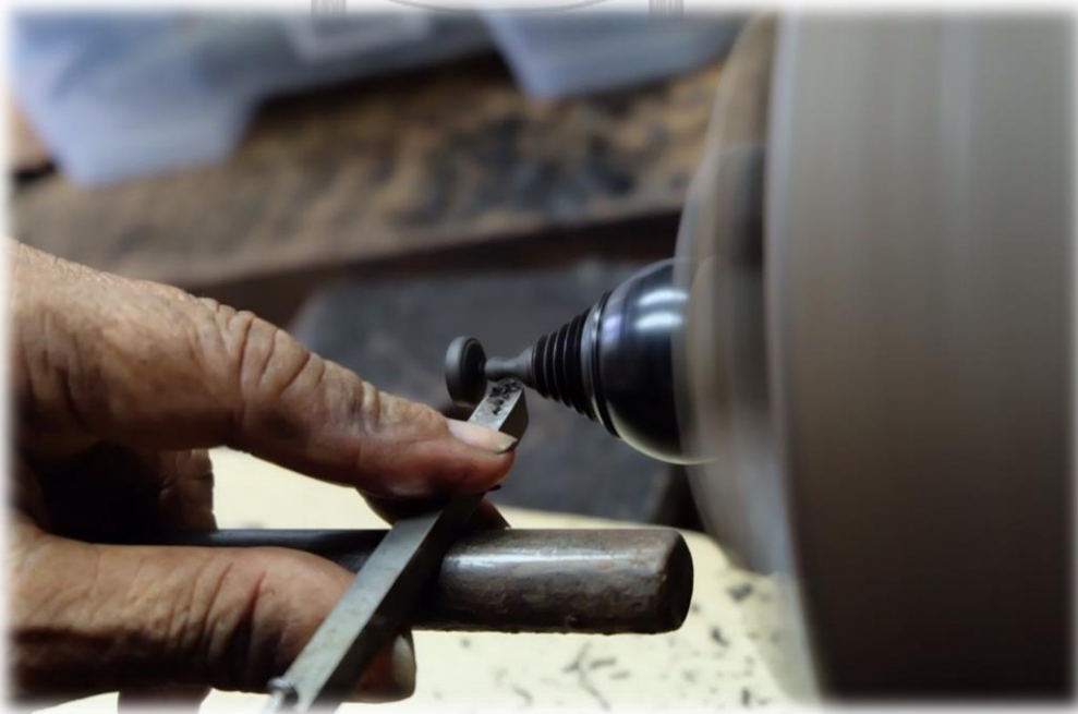
ภาพที่ 164 กลึงยอดฉัตรของลูกบิด
