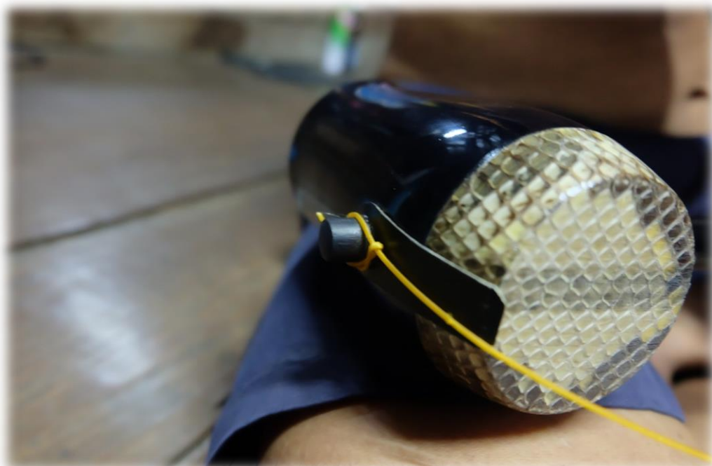
ภาพที่ 259 นำสายซอที่มีดปมคล้องให้กับเต็ยใต้กระบอกซอ
