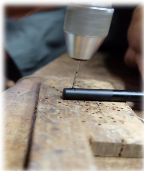
ภาพที่ 167 เจาะปลายก้านของลูกบิดสำหรับร้อยสายขอ
