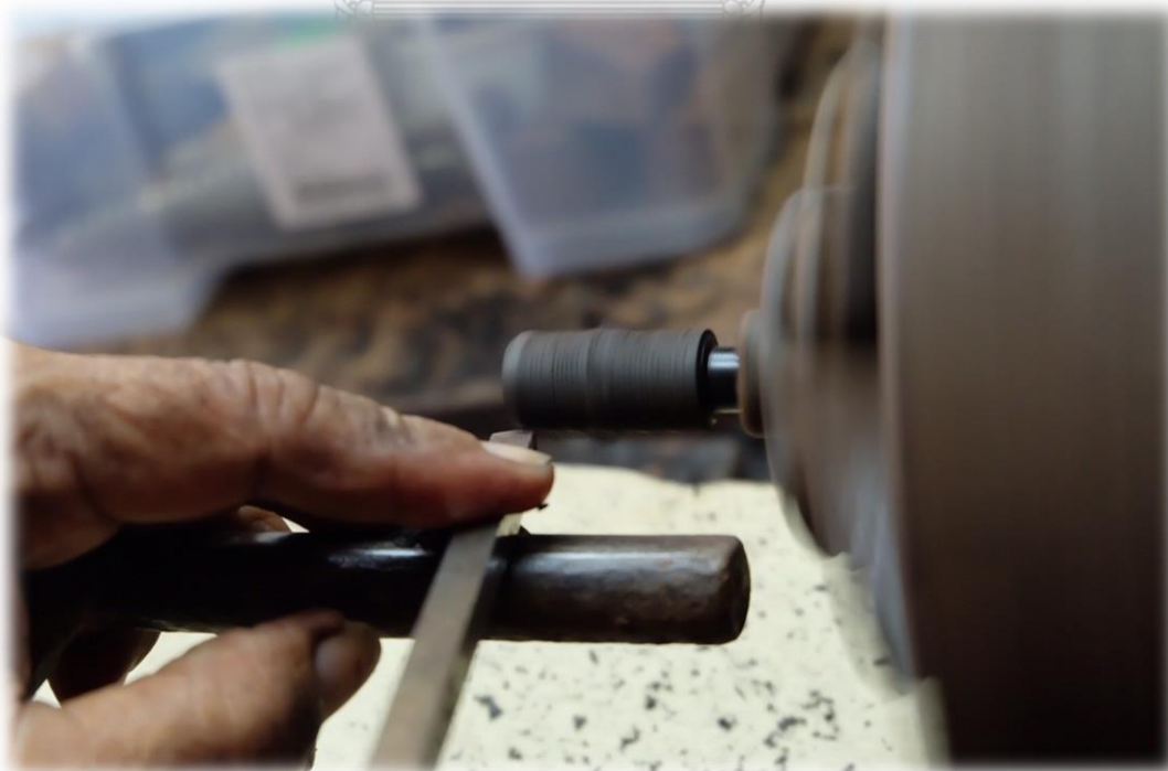
ภาพที่ 166 กลึงส่วนปลายของก้านลูกบิด
