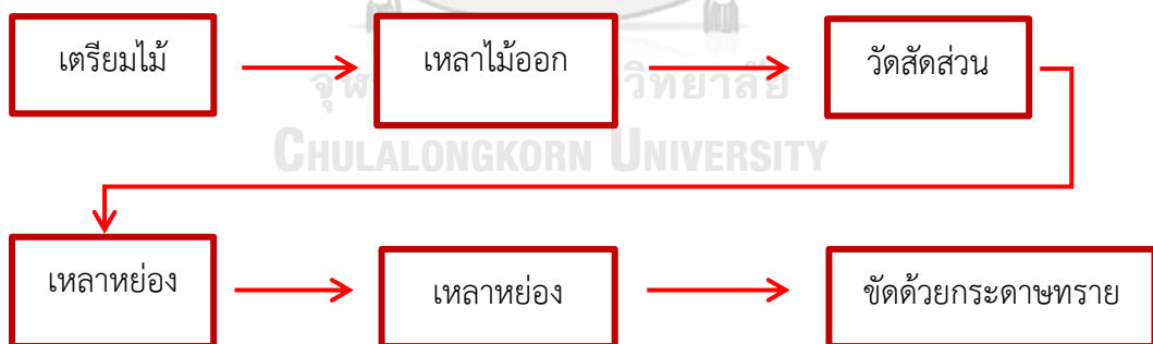
แผนภาพที่ 8 ขั้นตอนที่ 6 การสร้างหย่องซอด้าง
