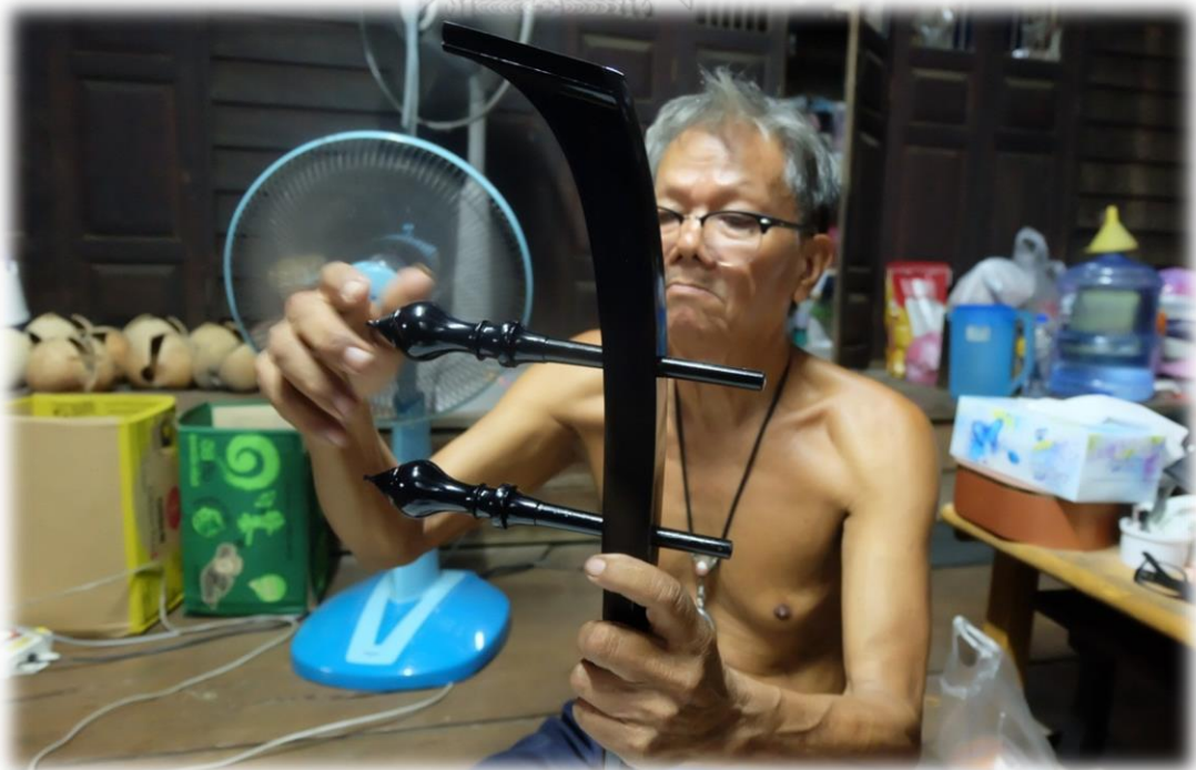
ภาพที่ 256 นำลูกบิดมาเสียบไว้กับคันทวน
