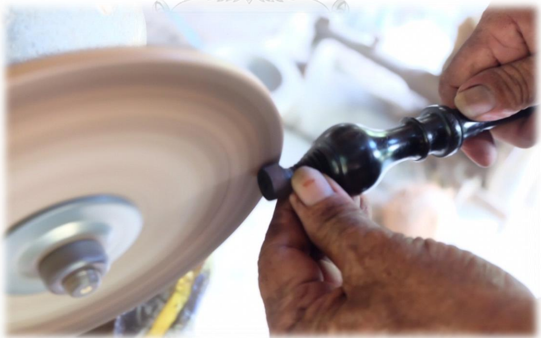
ภาพที่ 162 นำลูกบิดขัดกับเครื่องขัดสายพานไฟฟ้า
