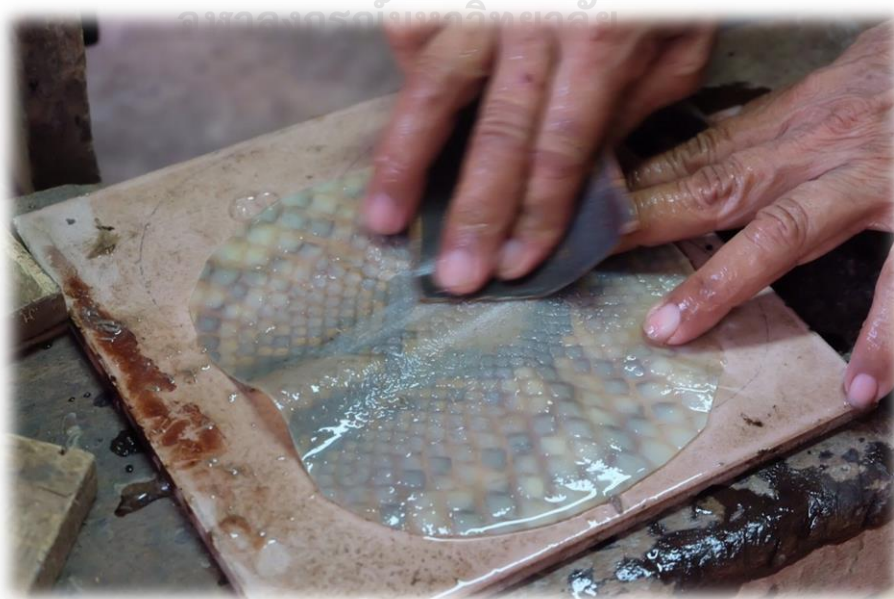
ภาพที่ 134 หนังงูขณะขัดกระดาษทรายบกร
