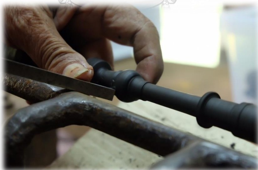
ภาพที่ 178 กลึงสร้างลวดลายของคันทิ้ง
