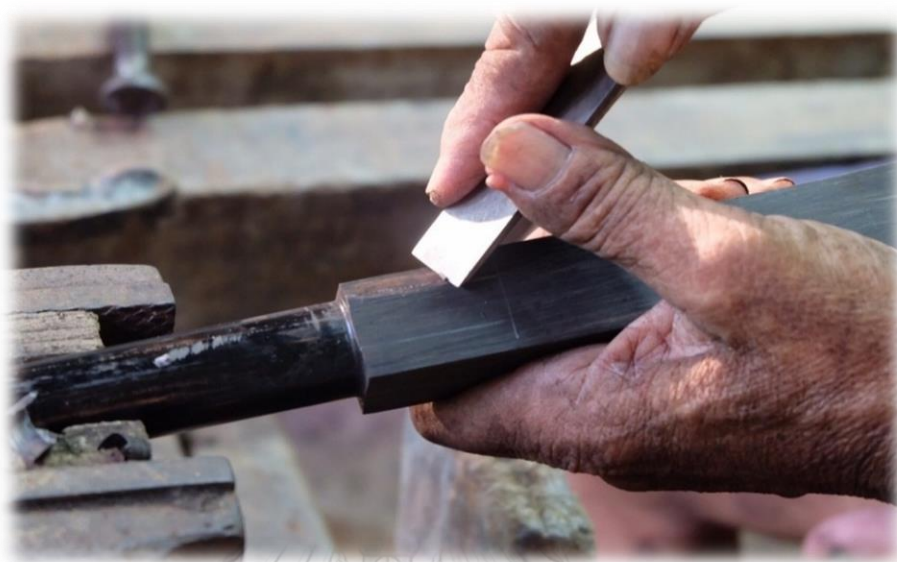
ภาพที่ 231 ใช้สิ่วบากเพื่อสร้างบัวบริเวณปลายโขน
