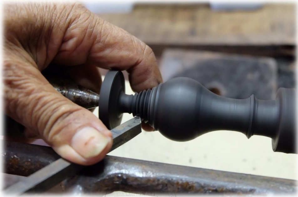
ภาพที่ 156 การกลึงฉัตรของลูกบิด
