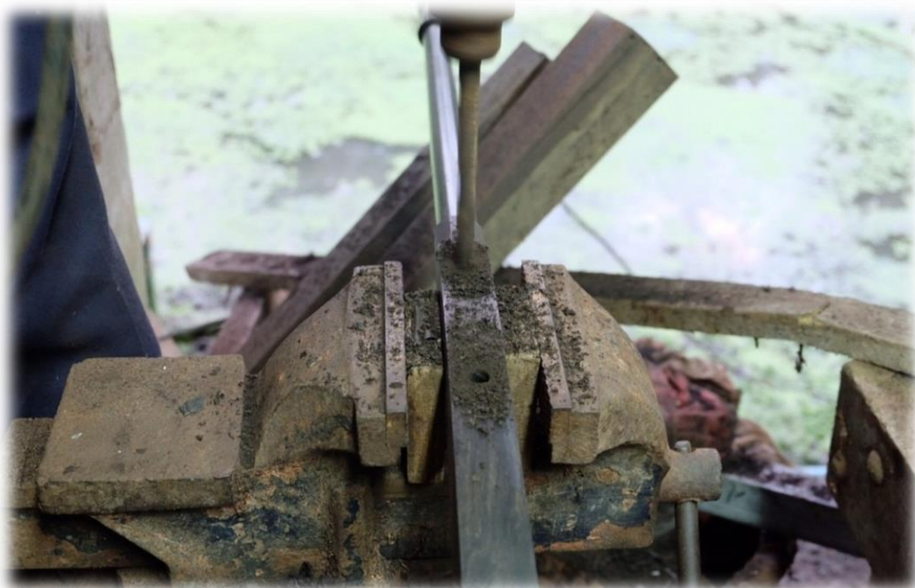
ภาพที่ 233 ทำการเจาะรูบริเวณโชนเพื่อใส่ลูกบิด
