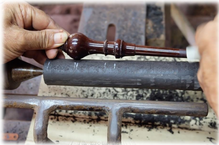
ภาพที่ 154 นำไม้เข้าแทนกลิ้งและวัดสัดส่วนจากลูกบิดต้นแบบ
