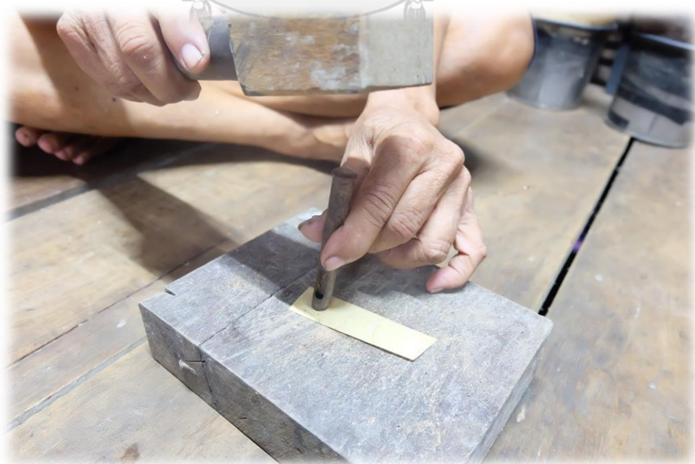
ภาพที่ 252 นำเหล็กตุ้มตอกลงบนแผ่นหนัง
