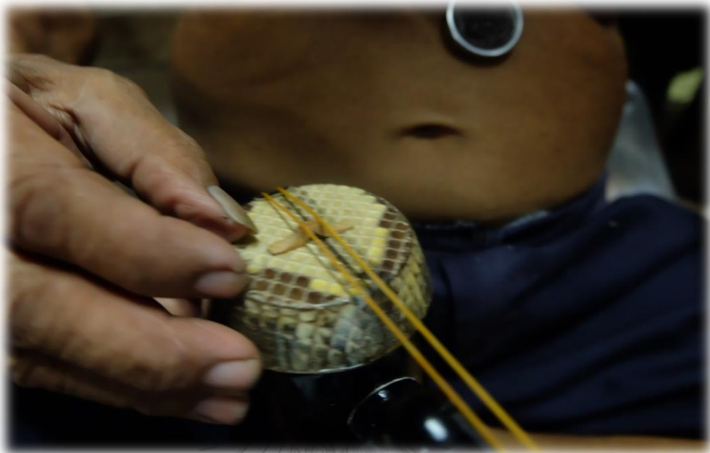
ภาพที่ 263 นำหย่องใส่ในระดับกึ่งกลางของหน้าซอ
