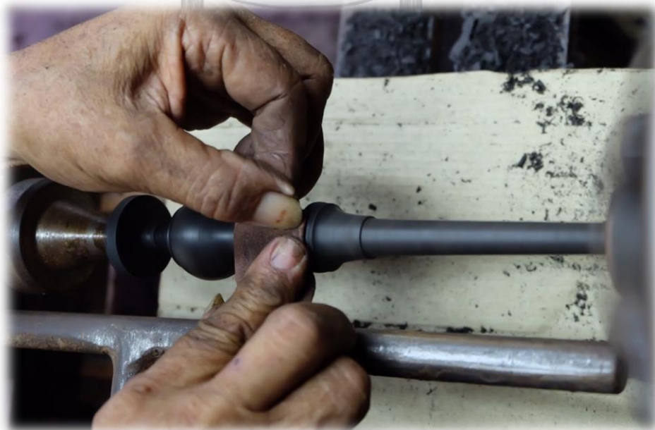
ภาพที่ 159 ใช้กระดาษทรายบดขัดลบรอยมีดกลึง
