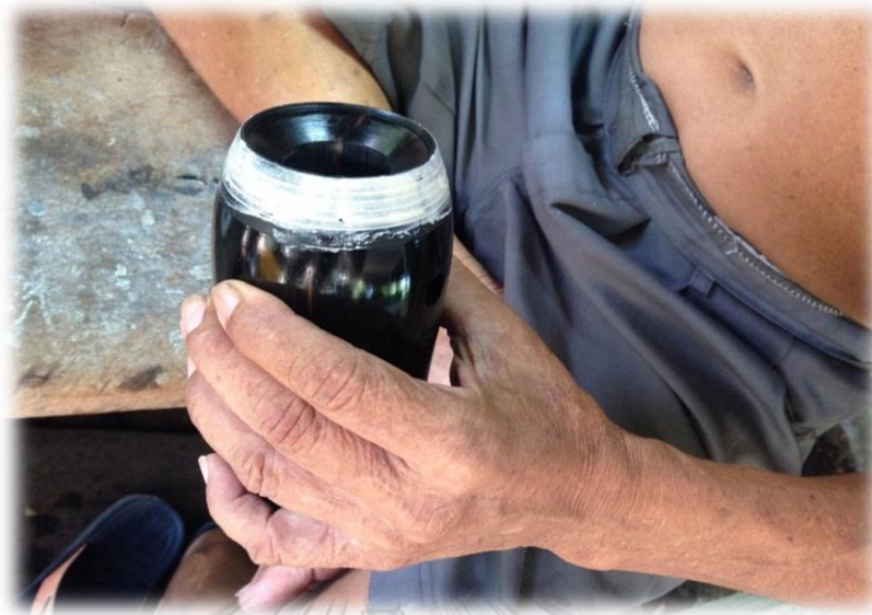
ภาพที่ 137 นำกาวมาพอกบริเวณที่ซักร่องลายไว้
