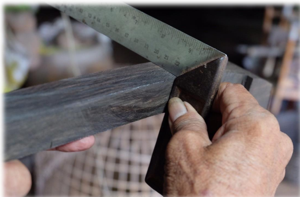
ภาพที่ 223 ทำการวัดขอบซอให้ได้มุมฉาก
