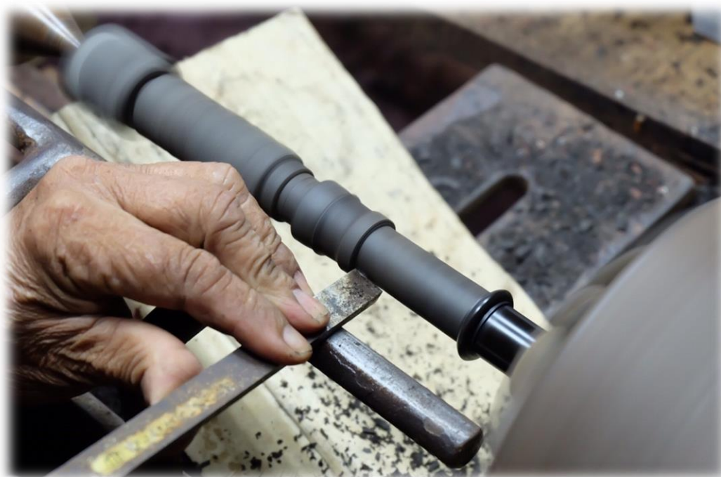
ภาพที่ 213 ใช้มีดกลึงเล็บกลึงสร้างลวดลาย
