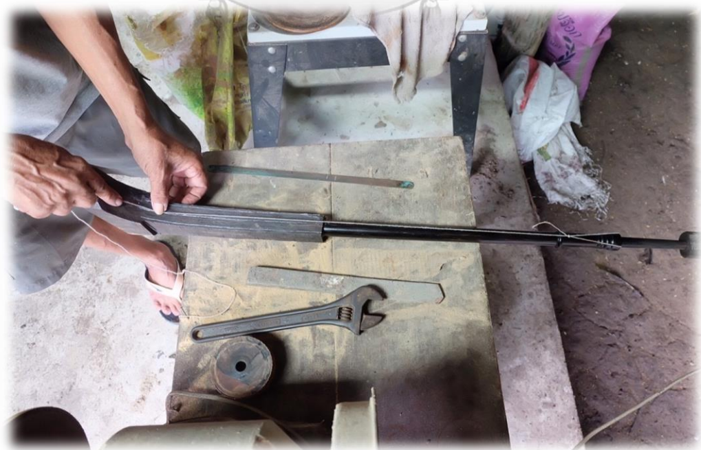
ภาพที่ 218 ทำการวัดจุดศูนย์กลางด้วยเชือกด้าย
