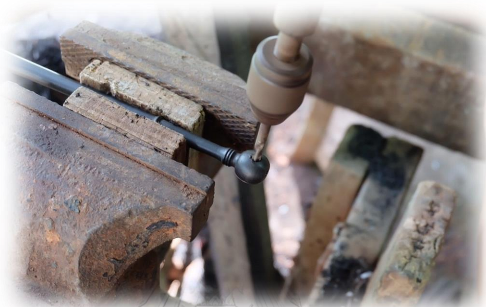
ภาพที่ 190 การใช้สว่านงานแบบมือหมุนเจาะบริเวณลูกตุ้ม
