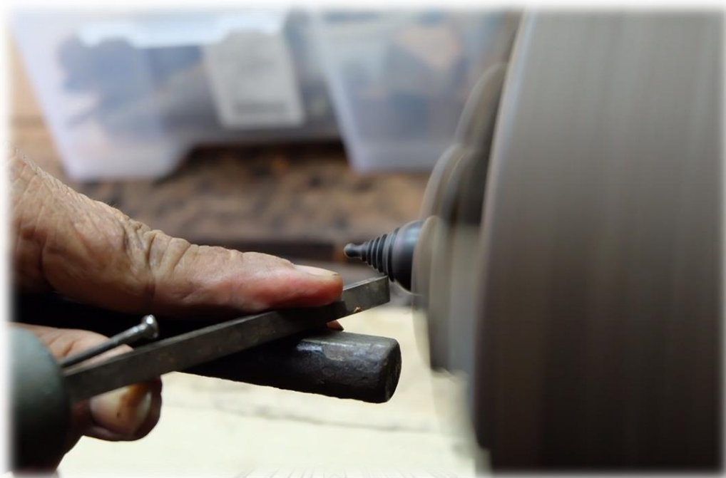
ภาพที่ 185 ทำการกรึงตบแต่งฉัตรทั้ง 3 ชั้น
