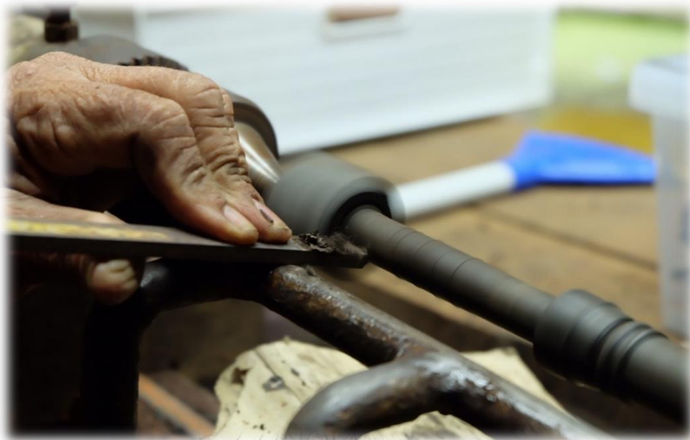
ภาพที่ 215 กลึงเตี้ยเสียบกระบอกขอม
