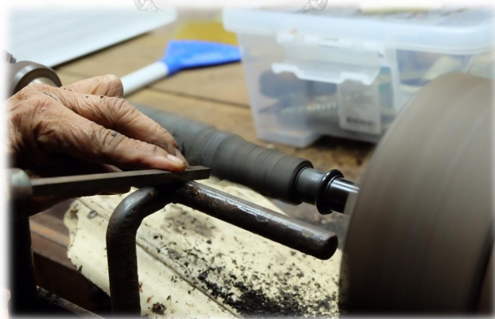
ภาพที่ 212 กลึงในส่วนของเหยียบกะโหลก
