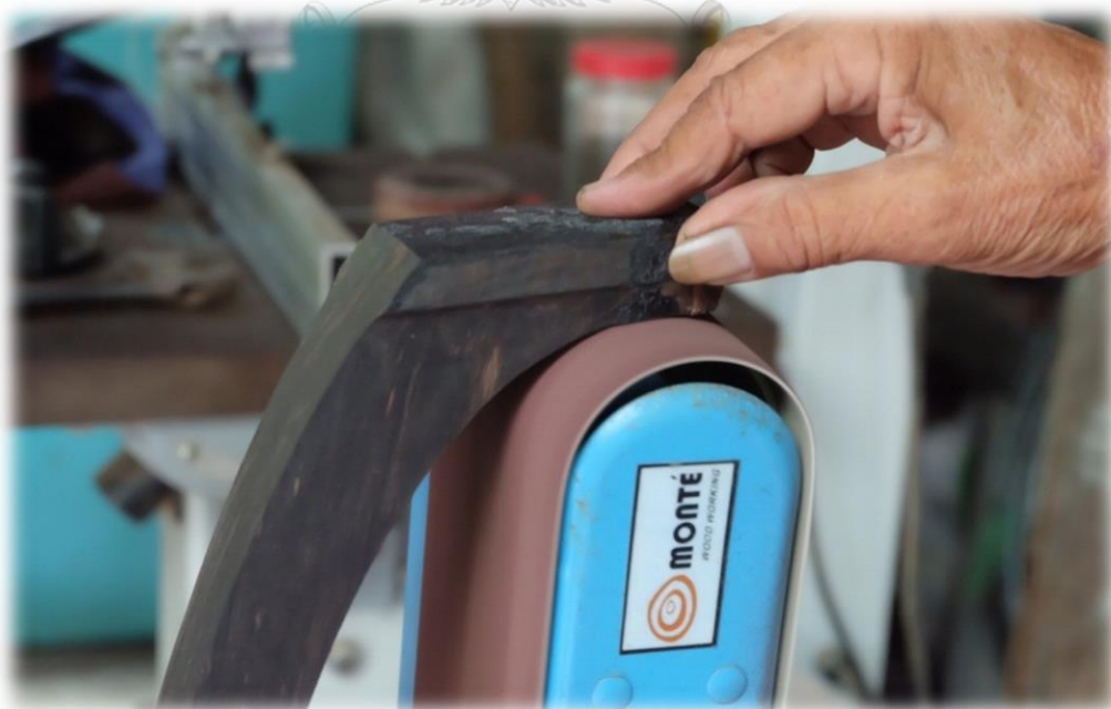
ภาพที่ 228 นำไขนซอมาขัดกับเครื่องขัดกระดาษทรายสายพานไฟฟ้า
