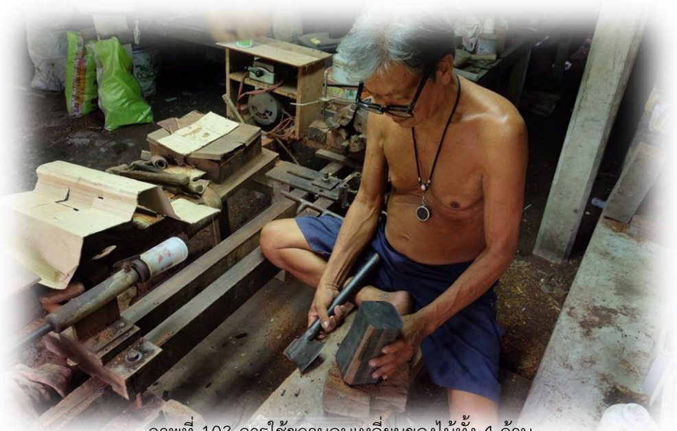
ภาพที่ 103 การใช้ขวานลบเหลี่ยมของไม้ทั้ง 4 ด้าน
