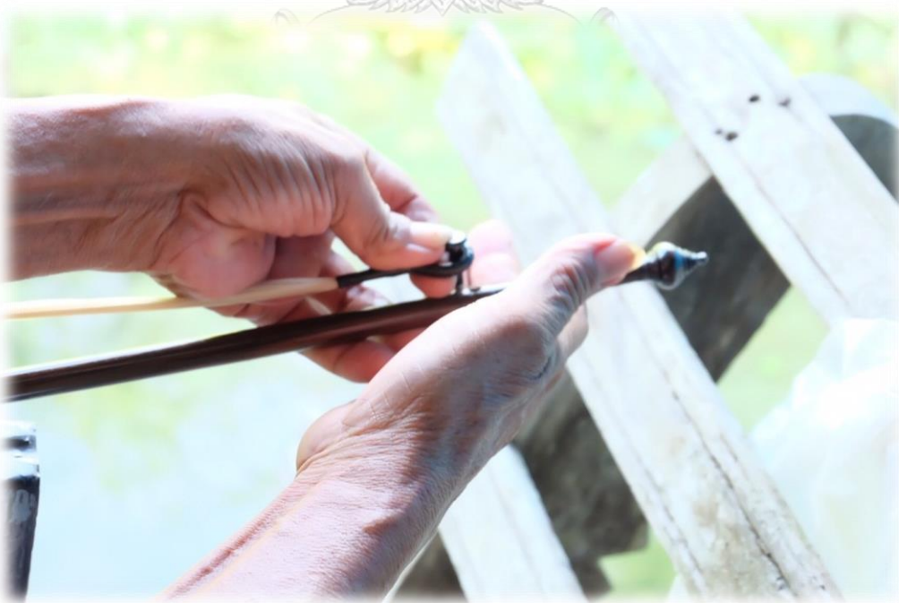
ภาพที่ 198 นำหางม้าคล้องไว้กับหมุดและปักลงบนคันทันชักซอ
