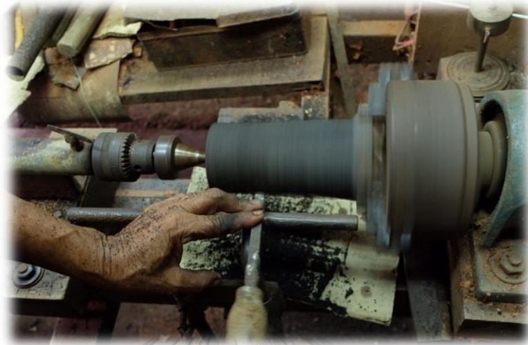
ภาพที่ 107 ใช้มีดกลึงลำไม้จนได้รูปทรงกลม
