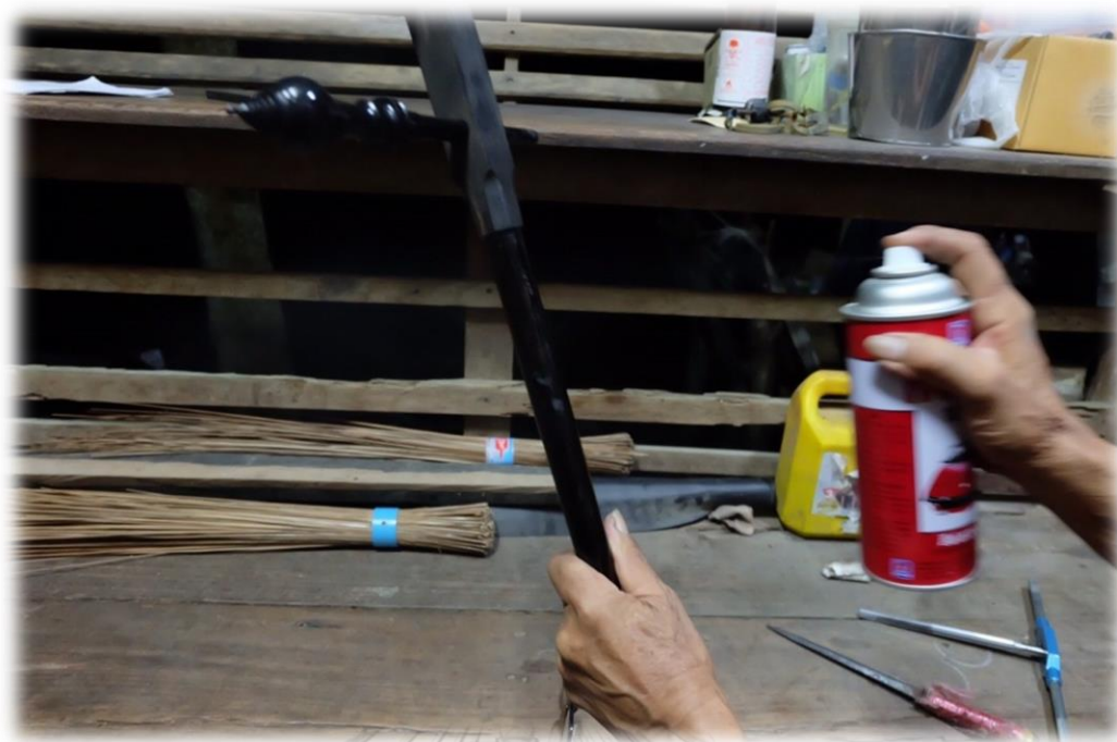
ภาพที่ 237 ฉีดพ่นแล็กเกอร์ลงบนคันทวน
