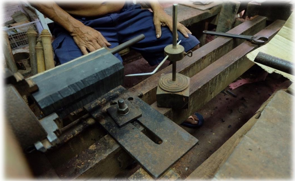
ภาพที่ 105 จัดไม้ให้อยู่กึ่งกลางโดยเครื่องเทียบศูนย์
