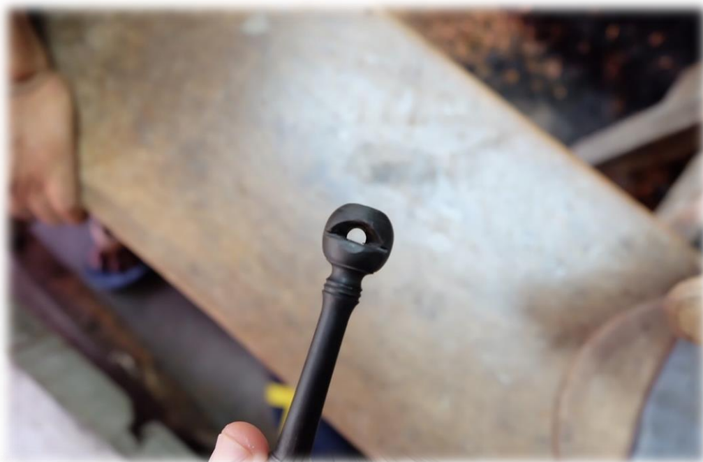
ภาพที่ 189 ลักษณะรูปทรงที่ทำการบากปากกรูแล้ว
