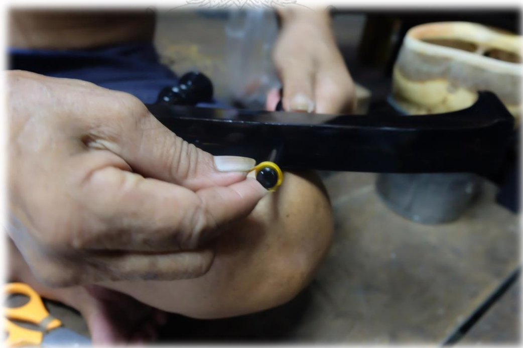
ภาพที่ 260 พันสายลูกบิด หมุนให้สายตึง
