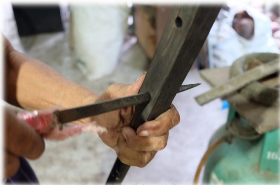
ภาพที่ 235 ใช้เหล็กกวาดรูล้างรูที่เจาะให้เรียบเนียน
