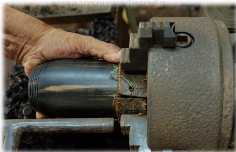
ภาพที่ 122 นำปากกระบอกซอหุ้มยางหนังแล้วล็อกไว้กับแท่นกลึง
