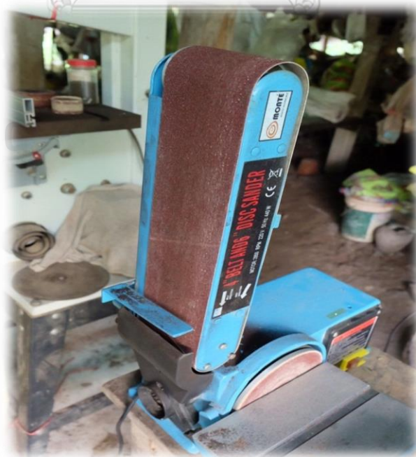
ภาพที่ 92 เครื่องขัดกระดาษทรายสายพานไฟฟ้า
