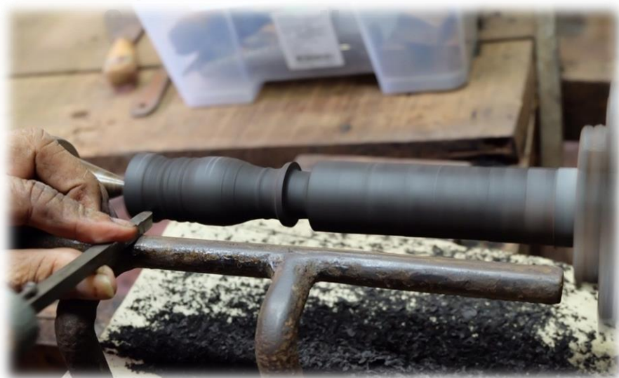
ภาพที่ 155 กลิ้งสร้างลวดลายของลูกบิด
