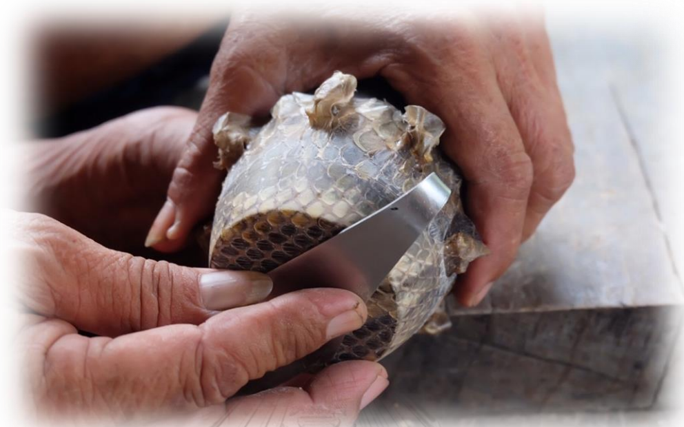
ภาพที่ 144 ใช้ขอขีดเส้นลงบนขอบหนัง
