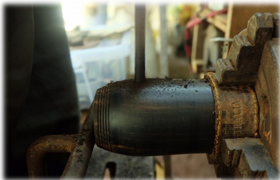
ภาพที่ 125 เจาะรูกระบอกขอด้วง
