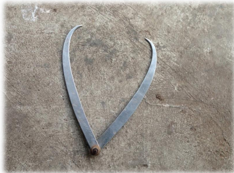
ภาพที่ 59 คาลิเปอร์วัดนอก (เขาควย)
