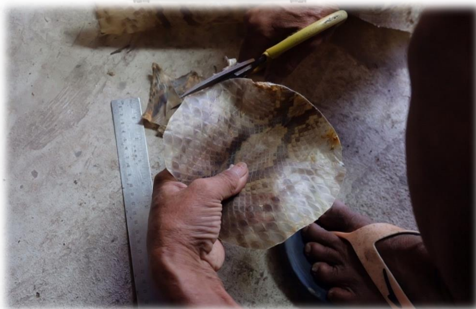
ภาพที่ 132 การตัดหนังงูให้มีลักษณะกลม
