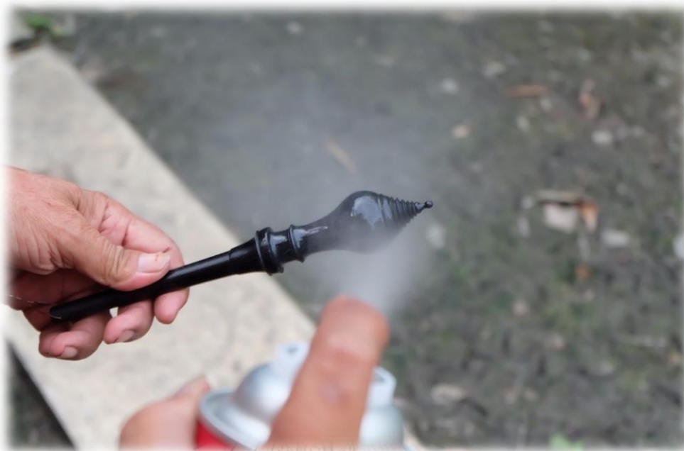
ภาพที่ 169 ฉีดพ่นแล็กเกอร์ลงบนลูกบิด
