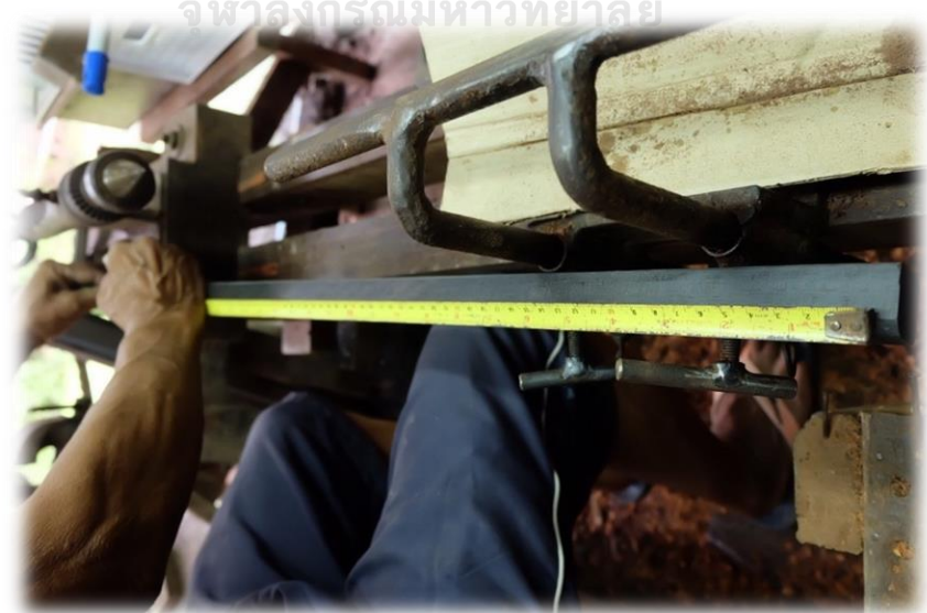
ภาพที่ 174 ทำการวัดสัดส่วนก่อนทำการกลึง
