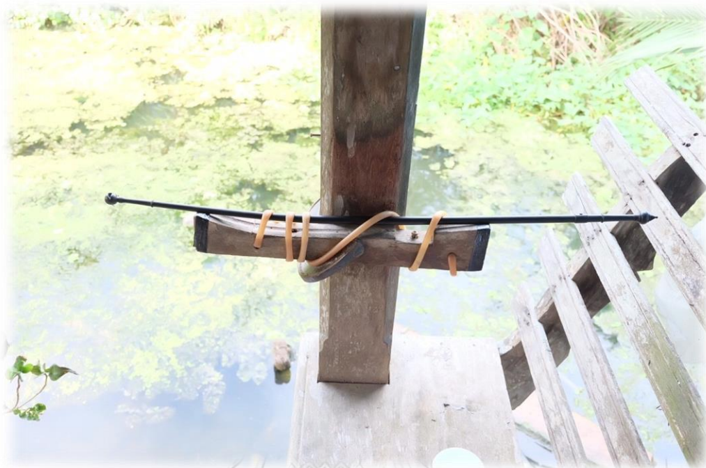
ภาพที่ 191 นำคันชักผูกมัดไว้กับเครื่องตัดคันชัก
