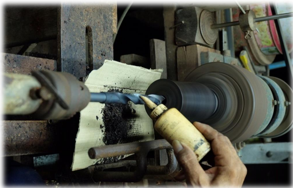
ภาพที่ 117 หยอดน้ำมันหล่อลื่นลงบนดอกสว่าน
