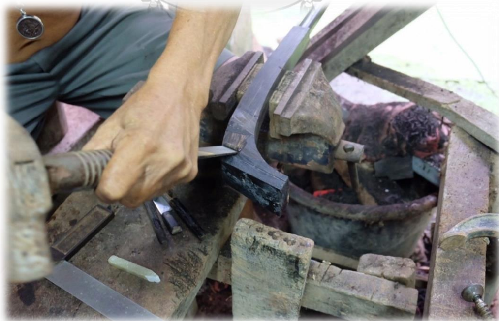
ภาพที่ 226 ใช้สิ่วบากสร้างเหล็กของโขน
