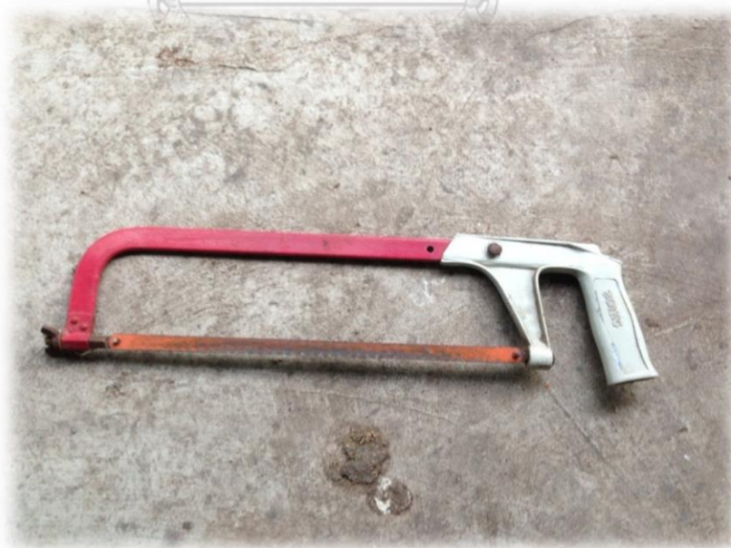
ภาพที่ 50 เลื่อยตัดเหล็ก
