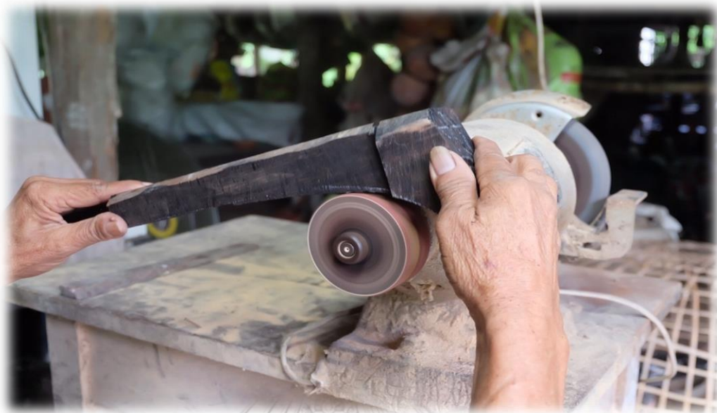
ภาพที่ 217 นำโขนซอขัดด้วยเครื่องขัดกระดาษทรายแบบแป้นหมุน
