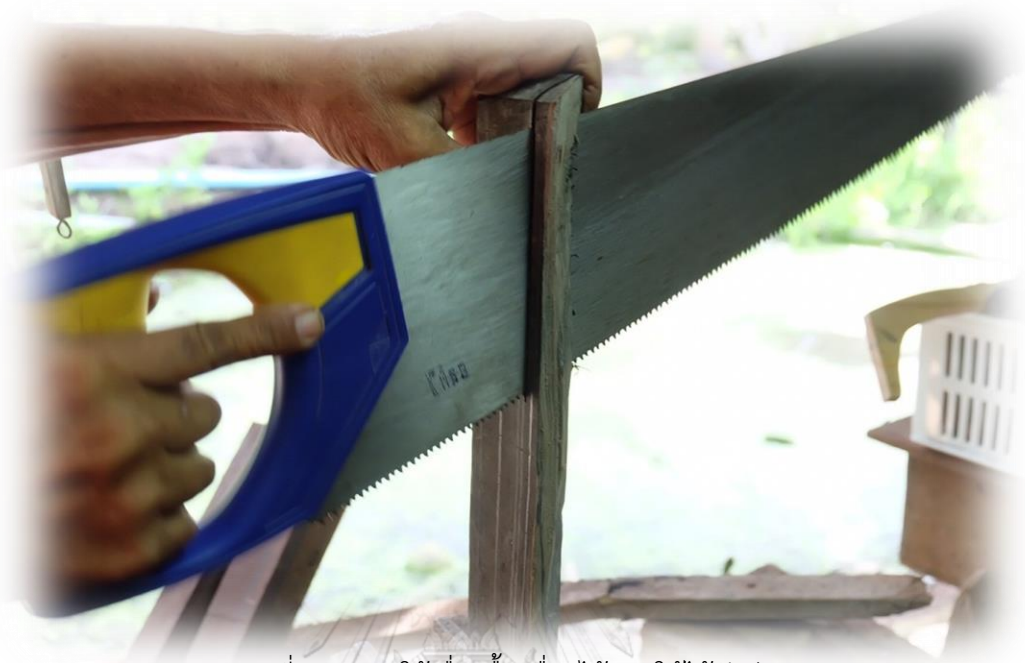
ภาพที่ 205 การใช้เลื่อยปั่นเลื่อยไม้ออกให้ได้สัดส่วน
