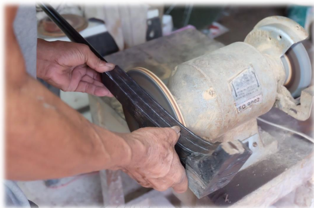
ภาพที่ 219 ชัดส่วนโขนให้ได้รูปทรงที่ต้องการ
