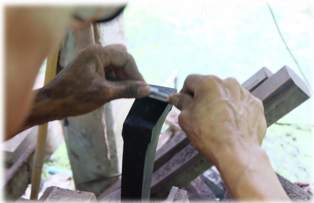
ภาพที่ 229 ใช้เชียดล้าไม้บริเวณหลังโขน
