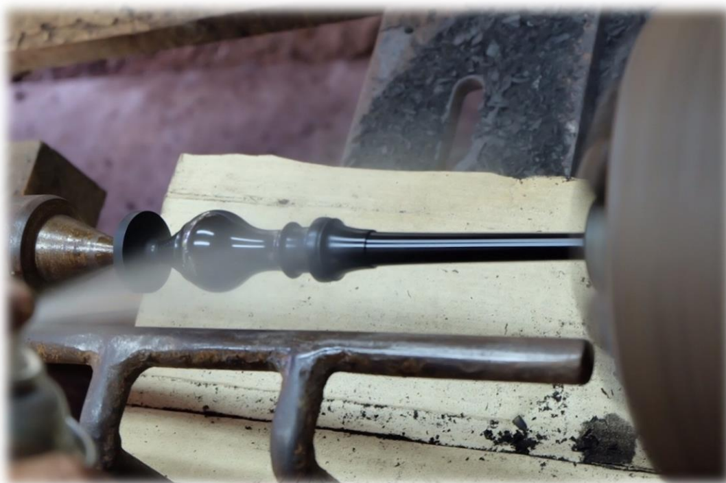
อ ฉีดพ่นแล็กเกอร์ลงบนลูกบิด
