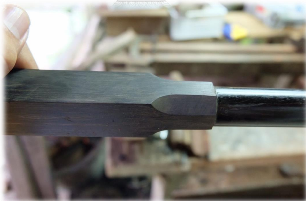
ภาพที่ 232 รูปทรงบัวคว่ำที่เสร็จเรียบร้อยแล้ว
