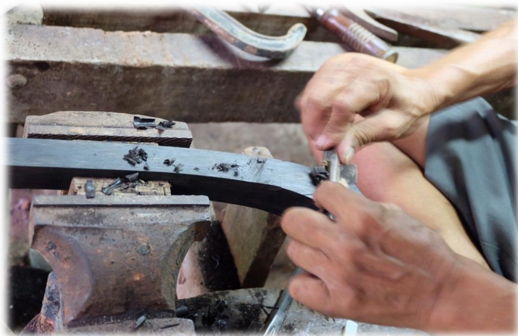
ภาพที่ 227 ใช้เชี้ยดล่างไม้บริเวณเหงือกของไขนให้เรียบ
