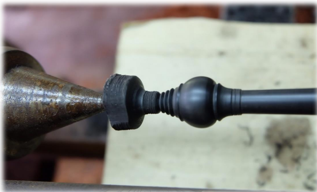
ภาพที่ 179 หัวเม็ดยี่ทำการกลึงฉัตร 3 ชั้น
