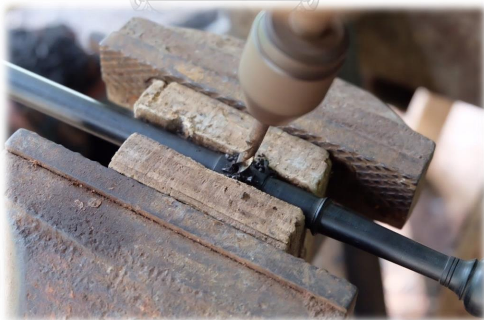
ภาพที่ 186 ใช้สว่านงานแบบมือหมุนเจาะรูหมุดยึดหางม้า
