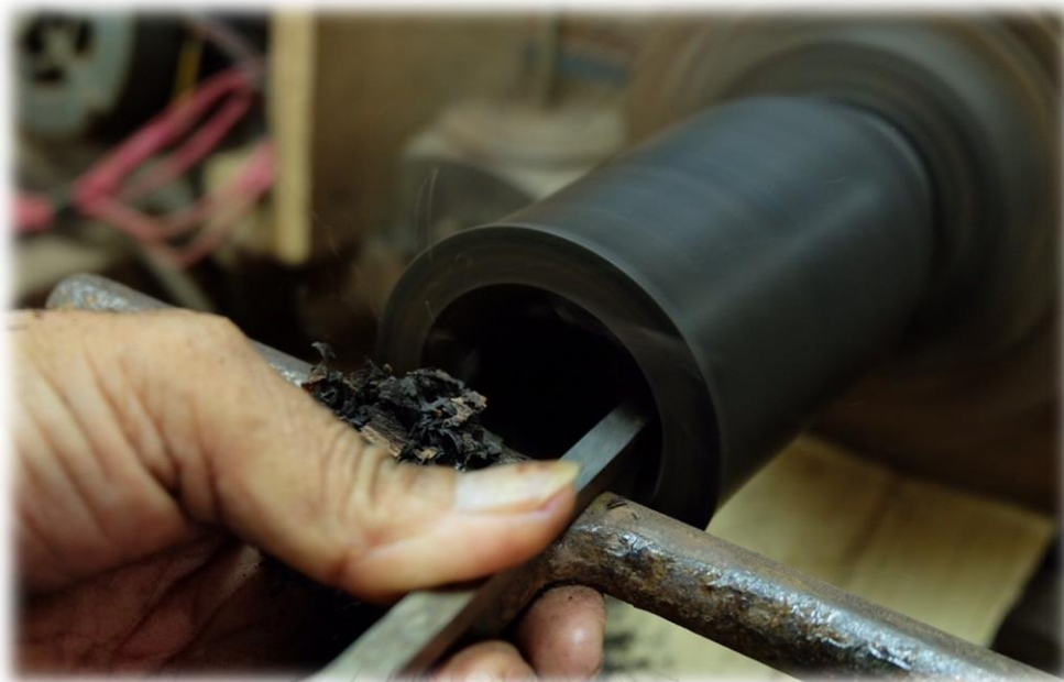
ภาพที่ 119 คว้านกระบอกซอด้านใน
