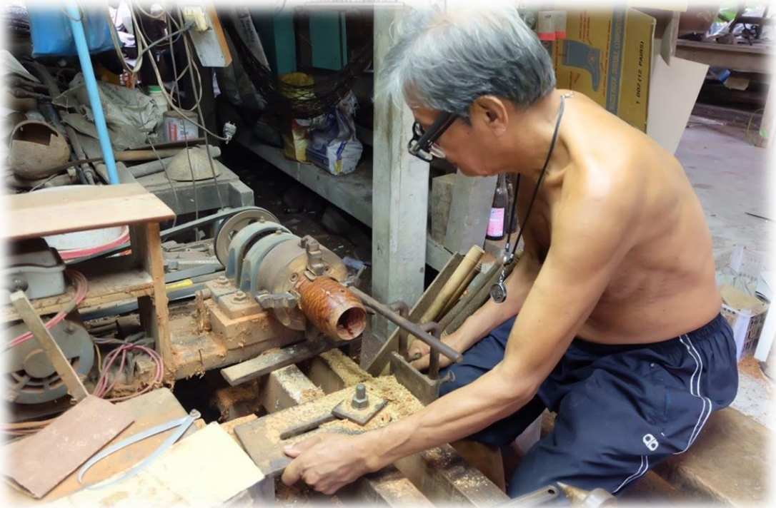
ภาพที่ 12 ครูประสิทธิ์ ทัศนกร ขณะกำลังเตรียมกลึงกระบอกลึง
