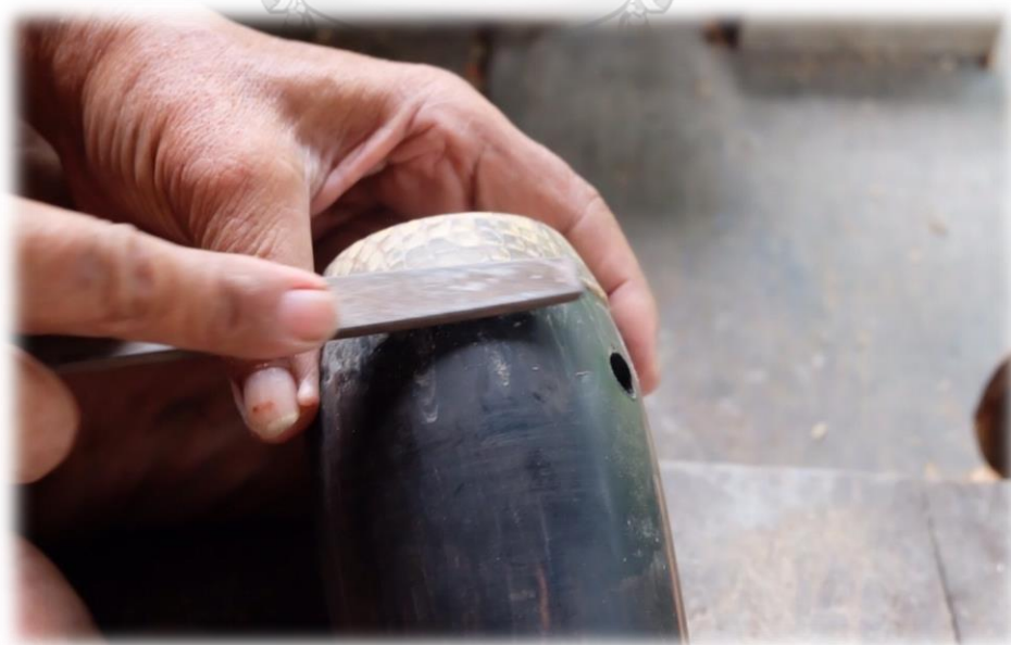
ภาพที่ 149 ใช้ตะไบขัดเพื่อลบบรอยกาว
