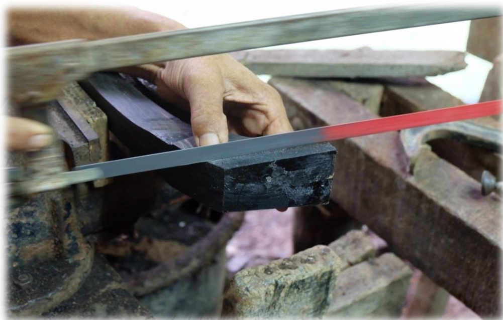
ภาพที่ 225 ใช้เลื่อยตัดเหล็กเลื่อยบริเวณส่วนโขน
