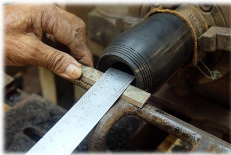
ภาพที่ 124 ร่องเสียงมีความลึก 1 เซนติเมตร
