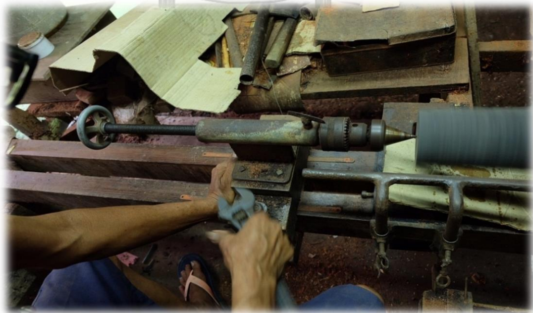
ภาพที่ 106 ใช้แป้นจี๊ดจุดศูนย์กลางของไม้
