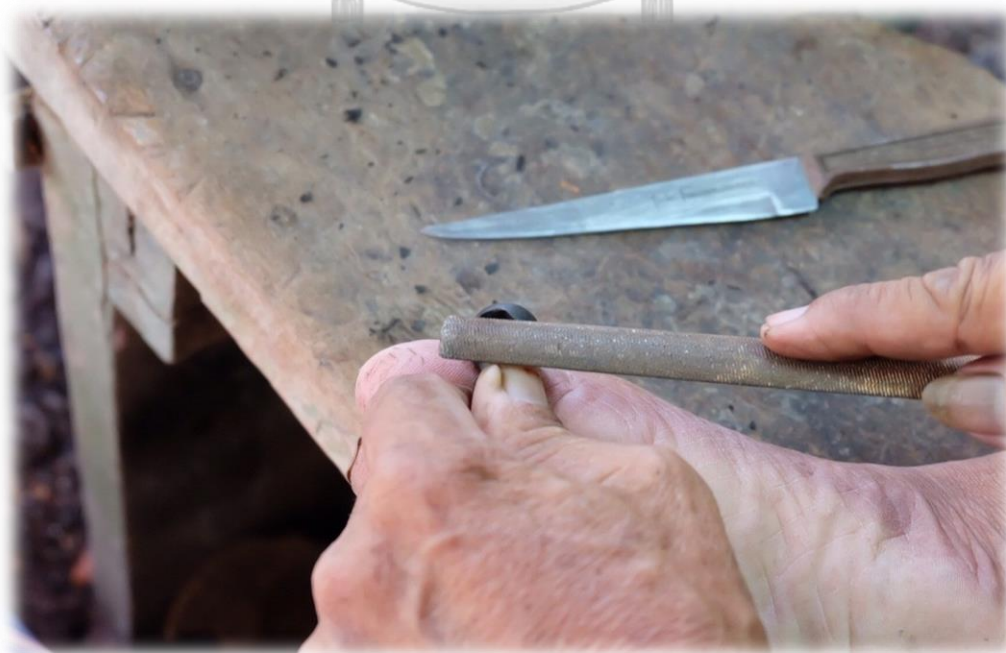
ภาพที่ 188 นำตะไบไปถูลบคมมีดบริเวณปากกรูที่บาก
