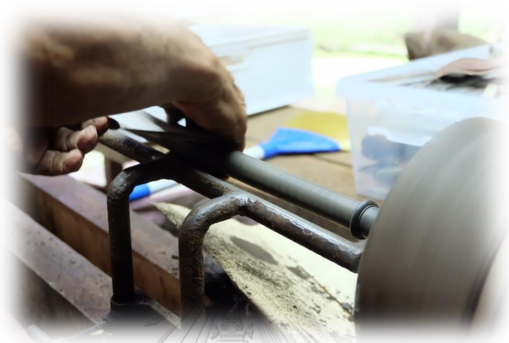
ภาพที่ 211 ใช้กระดาษทรายขัดคันทวนที่ทำการกลึง
