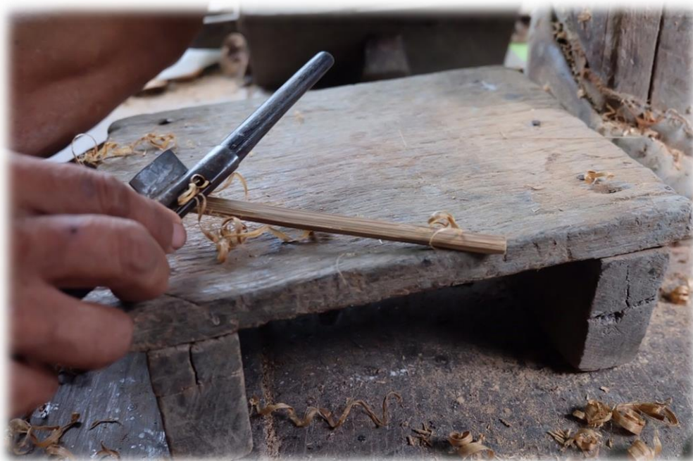
ภาพที่ 240 ใช้เซียดไสลบเหลี่ยมไม้
