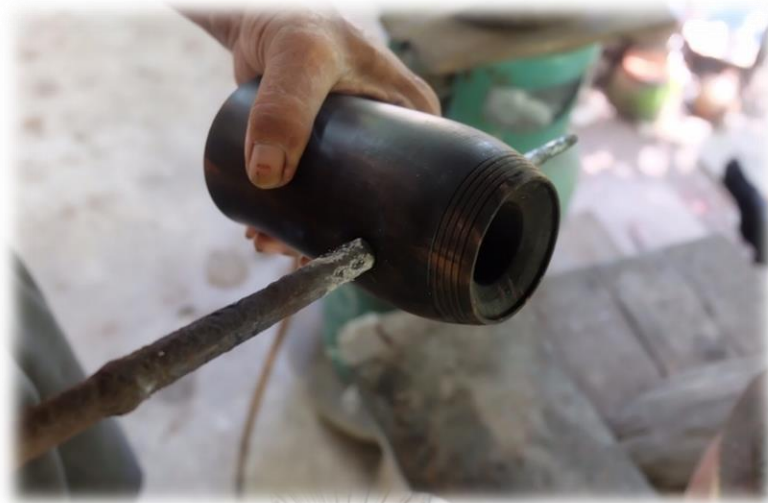
ภาพที่ 127 นำเหล็กคว้านมาขยายรูกระบอกซอ
