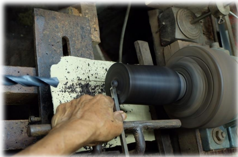
ภาพที่ 115 ใช้มีดกลึงฉากเล็กกลมไม้ออกจากปากกระบอกซอ
