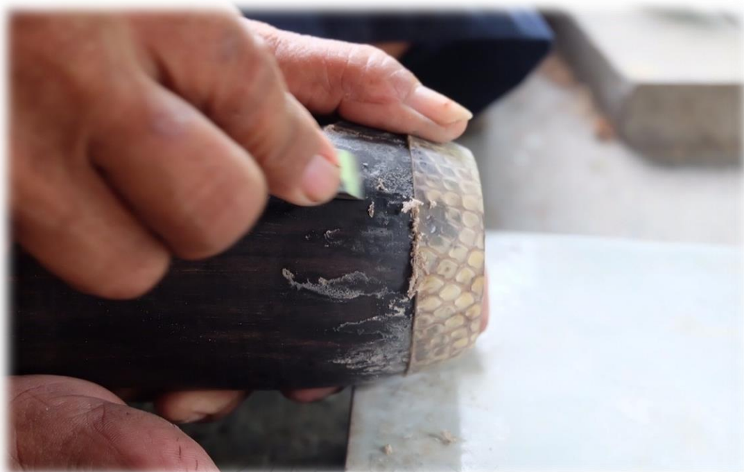
ภาพที่ 148 ใช้สว่านควดคราบกาออก
