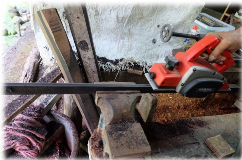
ภาพที่ 173 ใช้กบไสไม้ไฟฟ้าขัดเนื้อไม้ให้เรียบ
