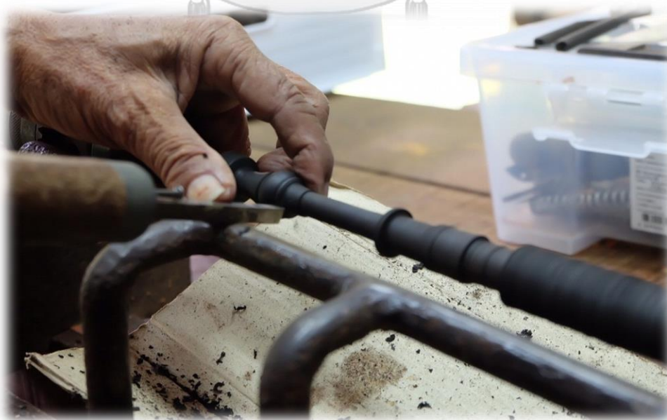
ภาพที่ 176 กลึงสร้างรูปทรงคันชัก
