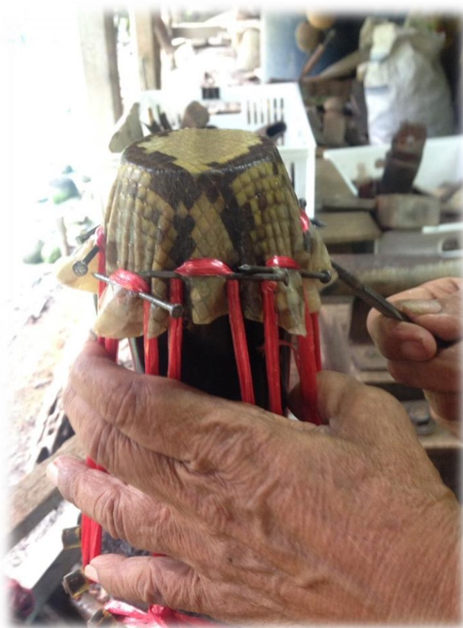
ภาพที่ 140 ใช้ตะขอดึงหนังที่ทับกัน
