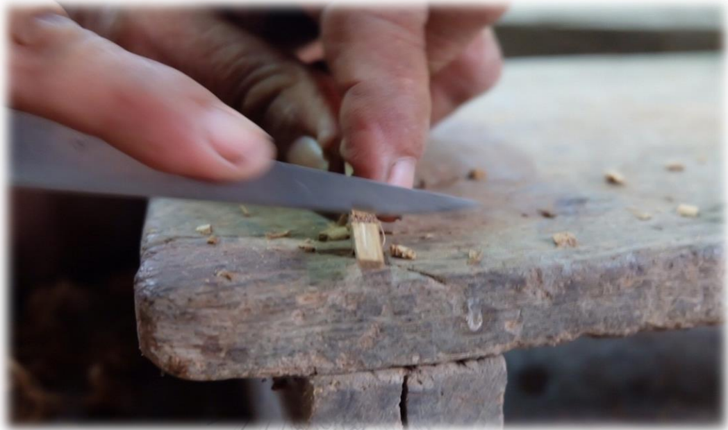
ภาพที่ 242 ใช้มีดเลาะท้องของหย่อง
