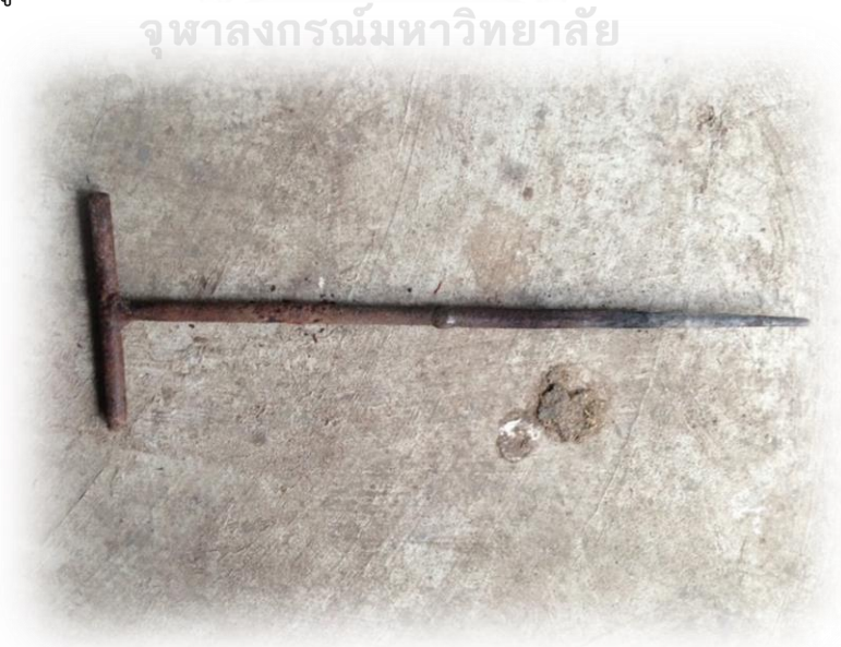
ภาพที่ 60 เหล็กคว้านขยายรู
