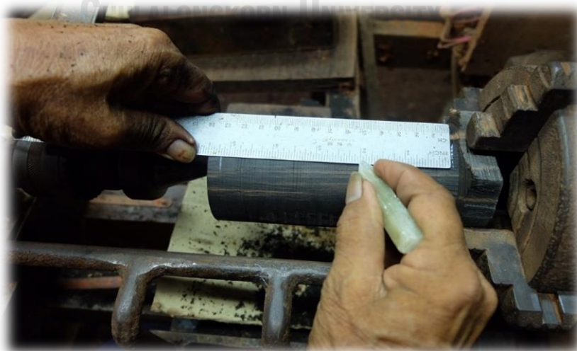
ภาพที่ 108 วัดเพื่อกำหนดการสร้างรูปทรงกระบอกซอ
