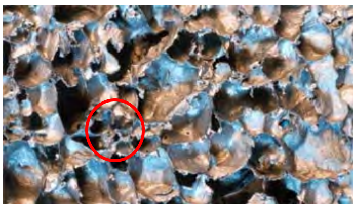
รูปที่ 2.25 แสดง โครงสร้างโฟมโลหะที่มีจุดบกพร่อง [28]
