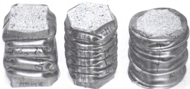
รูปที่ 2.55 แสดงพฤติกรรมการรับแรงอัดที่มีต่อหน้าตัดท่อที่แตกต่างกัน [50]
