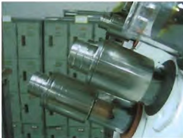
รูปที่ 20. แสดงท่อรับรังสีประกอบด้วยท่อทองแดงภายในบรรจุน้ำมันปาล์มเพื่อดูดซับพลังงานแสงอาทิตย์
