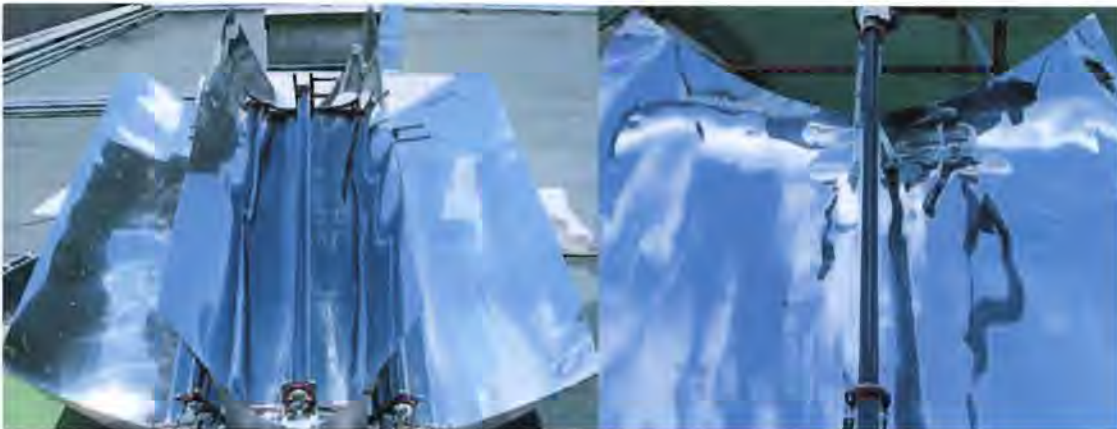
รูปที่ 12. ต้นแบบแผงรับแสงอาทิตย์ที่ไม่ใช้ระบบติดตามดวงอาทิตย์ตัวแรกขนาด 1.4x1.4 ม. (ซ้าย) และรางพาราโบลาแบบทั่วไปขนาด 1.4x1.2 ม. (ขวา) [1-2]
