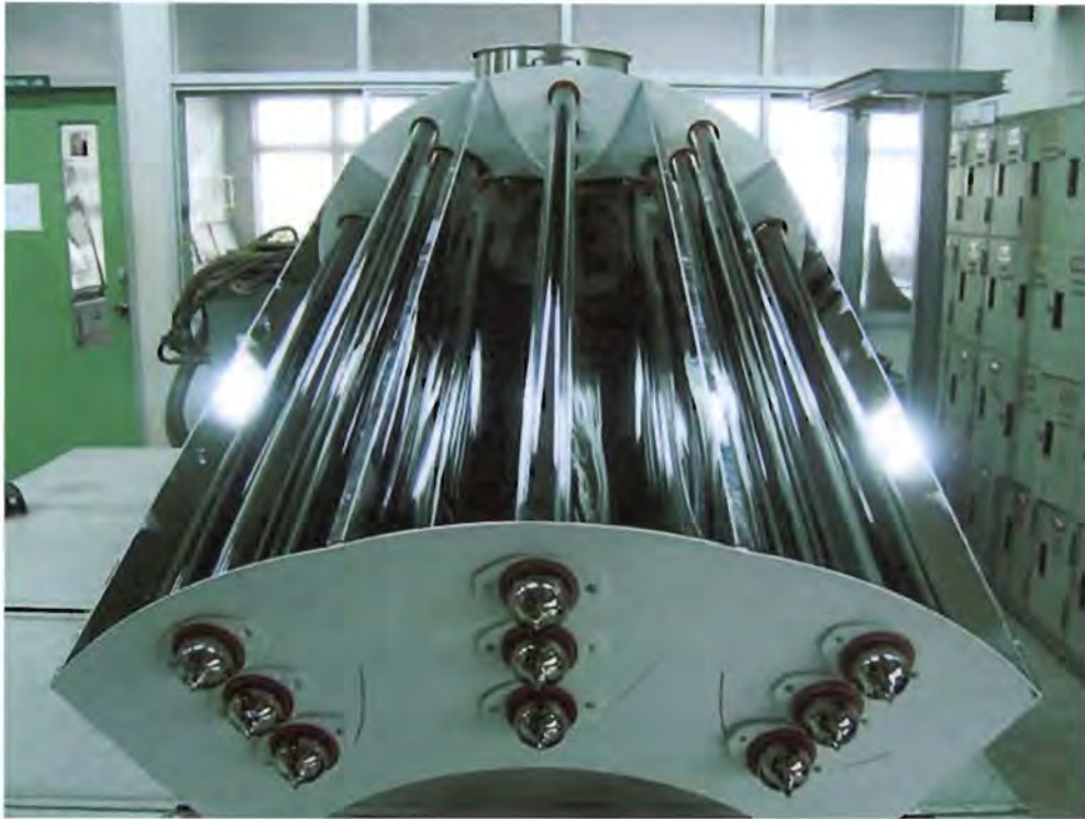
รูปที่ 3. ต้นแบบแผงรับแสงอาทิตย์แบบรางพาราโบลาที่ ไม่ต้องใช้ระบบติดตามดวงอาทิตย์
