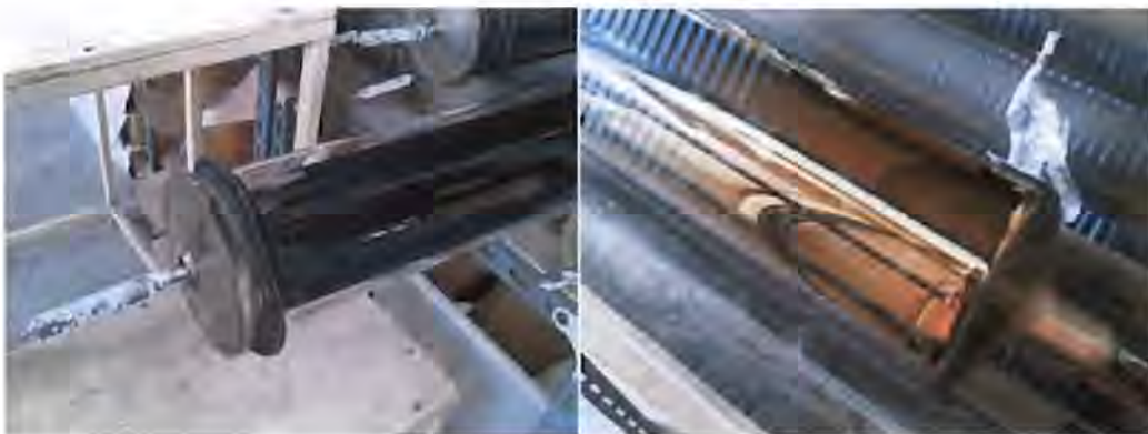
รูปที่ 31. แสดงท่อรับรังสียี่ห้อ SUNDA เส้นผ่านศูนย์กลาง 10 ซม. ยาว 216 ซม. สามารถทำอุณหภูมิสูงสุดที่ 190 องศาเซลเซียส
