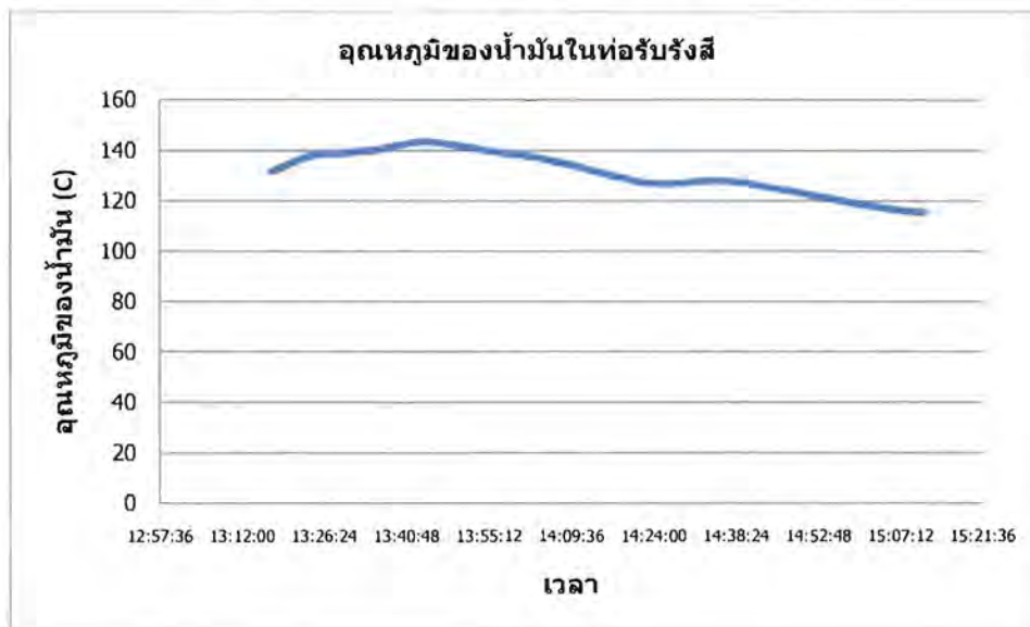
รูปที่ 22. แสดงอุณหภูมิภายในท่อรับรังสีที่มีน้ำมันปาล์ม 0.5 ลิตรบรรจุอยู่ในท่อ ทำการทดลองในวันที่ 29 พย. 53 โดยเริ่มทำการทดลองเวลา 12.30 น.
