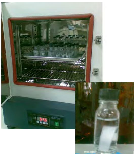
รูปที่ 3.6 ลักษณะของการทดสอบการไฮโดรไลซิสแผ่นฟิล์มตัวอย่าง
