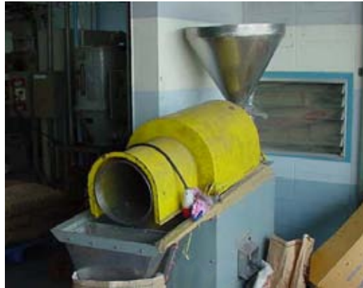
รูปที่ 4.7 แสดงเครื่องร่อนที่ใช้ในการแยกสิ่งเจือปนออกจาก Scrap
