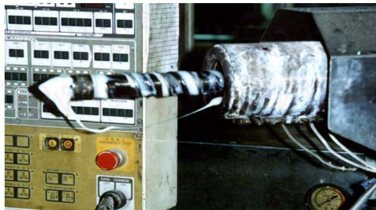
รูปที่ 4.10 แสดงเศษพลาสติกเหลวที่ติดค้างในสกรู
