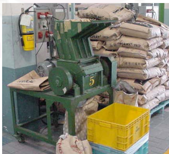
รูปที่ 4.6 แสดงสภาพเครื่องบดที่ใช้ในการเตรียม Scrap
