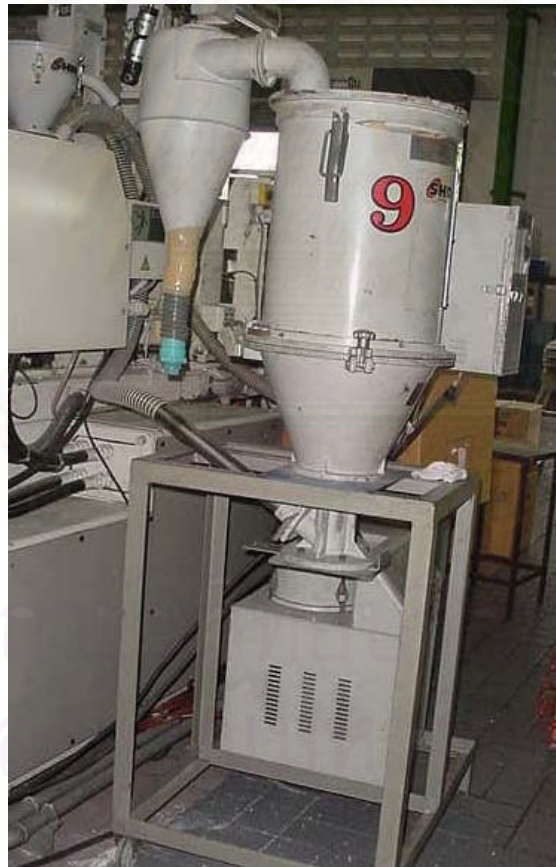
รูปที่ 4.8 แสดงตู้ฮอปเปอร์ (Hopper) และชุดอุปกรณ์ในการนำเม็ดพลาสติกเข้าเครื่องฉีด
