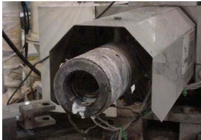
รูปที่ 4.9 แสดงกระบอกฉีดที่ต้องทำความสะอาดทุกครั้งก่อนเริ่มงานใหม่
