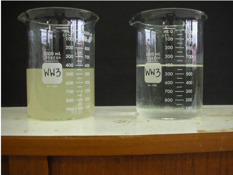
น้ำเสียที่ผ่านบำบัดโดยใช้ขี้เถ้าลูมิเนียม – แกรไฟต์ (อัตราการไหล 4 ลิตร/ชั่วโมง กระแสไฟฟ้า 2 แอมแปร์)
