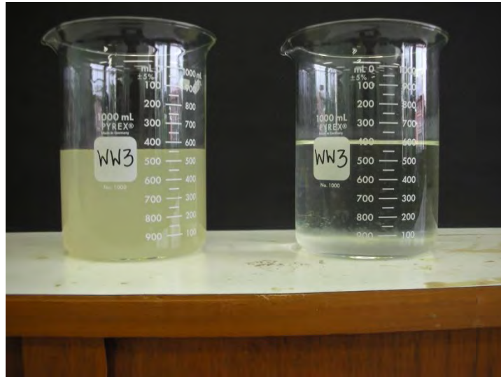
รูปที่ 4.17 น้ำเสียก่อน-หลังทำปฏิกิริยา (อัตราการไหล 4 ลิตร/ชั่วโมง กระแสไฟฟ้า 2 แอมแปร์ พีเอชเข้า 6.00 )
