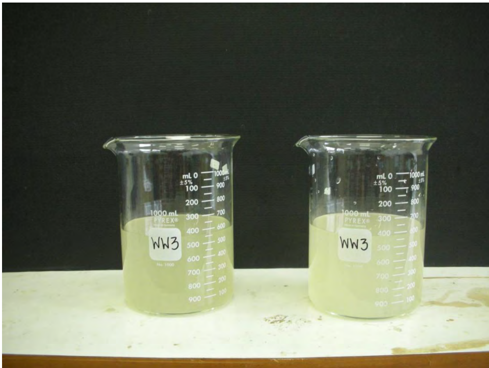
น้ำเสียที่ผ่านบำบัดโดยใช้ขี้แกรไฟต์ – แกรไฟต์ (อัตราการไหล 4 ลิตร/ชั่วโมง กระแสไฟฟ้า 3 แอมแปร์)
