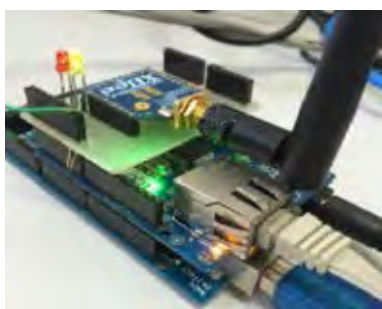
รูปที่ 2.7: เกตเวย์ตัวรับรู้สภาพแวดล้อมของโครงการ CUBEMS
