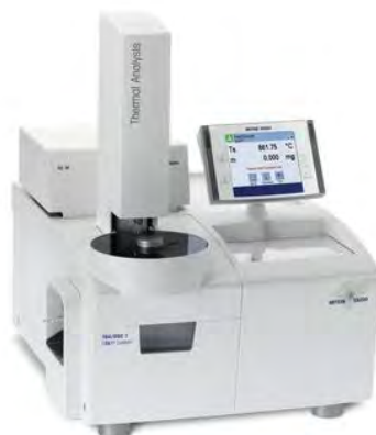
รูปที่ 3.5 เครื่อง Differential scanning calorimetry (DSC)
