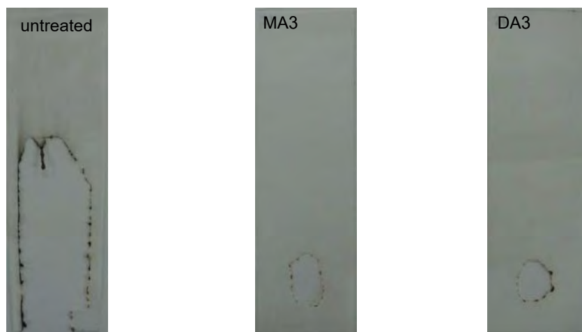
รูปที่ 4.8 ภาพของผ้าพอลิเอสเตอร์นอนวูฟเวนที่ผ่านการตกแต่งห่วงไฟด้วยเกลือแอมโมเนียมฟอสเฟตที่เหลืออยู่ภายหลังการทดสอบพฤติกรรมกรรมการติดไฟ การลามไฟ และการหลอมหยดของผ้าพอลิเอสเตอร์แนว 45 องศา
