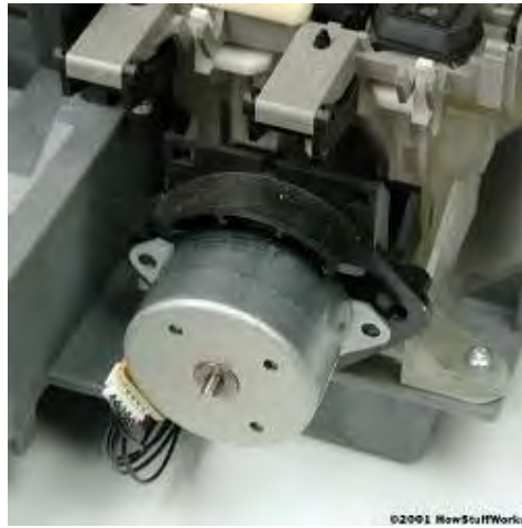
รูปที่ 2.7 มอเตอร์ควบคุมตำแหน่งหัวพิมพ์
