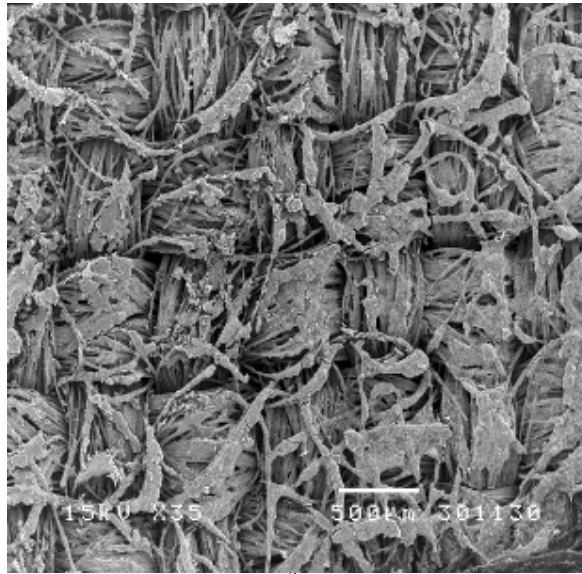
รูปที่ ข.3 ภาพถ่ายด้านบนของขั้วไฟฟ้าที่เตรียมด้วยวิธีการสเปรย์
