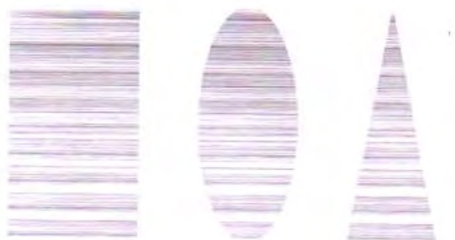
รูปที่ 4.1 ลักษณะการพิมพ์ที่ขาดความต่อเนื่องของหมึกพิมพ์ตัวเร่งปฏิกิริยาสูตรที่ 1
