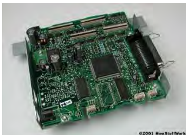
รูปที่ 2.9 วงจรควบคุมการทำงานของเครื่องพิมพ์
