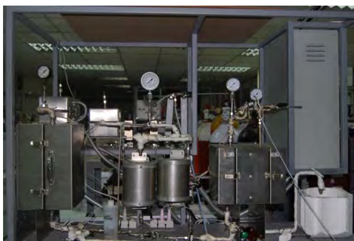
รูปที่ 3 กระบวนการการผลิตเชื้อเพลิงไฮโดรเจนที่มีความบริสุทธิ์สูง
