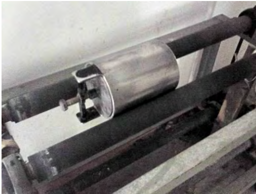
ภาพที่ ผ29 เครื่องบดขนาดเล็ก (Tube Mill)
