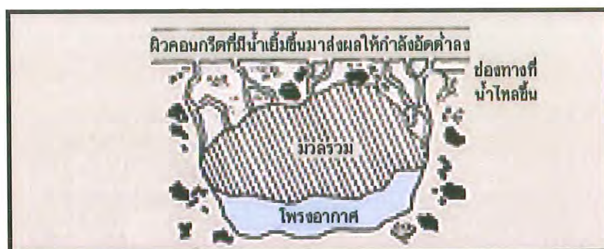
ภาพที่ 2.5 การเยิ้มของคอนกรีตก่อให้เกิดช่องว่างเรียงตัวในทิศทางเดียว
