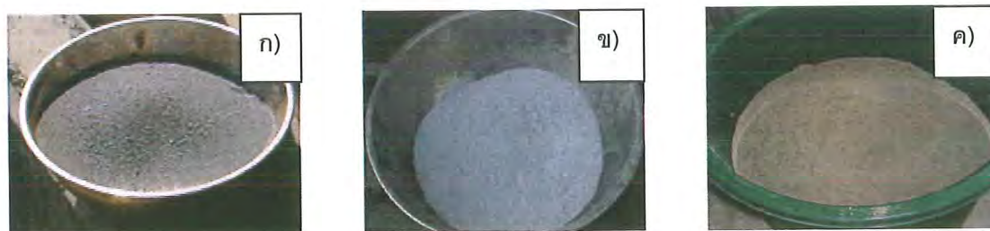
ภาพที่ 4.1 ภาพวัสดุที่ใช้ในการทดลอง ก) ของเสียซีลิกา ข) ซีลิกาฟุ้ง ค) ซีเมนต์
