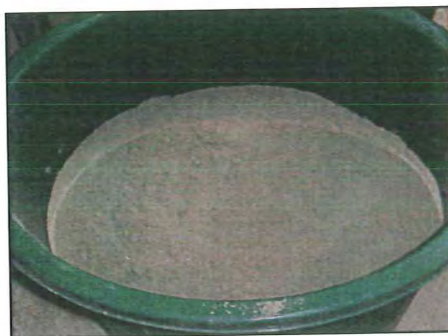
ภาพที่ 3.1 ปูนซีเมนต์ปอร์ตแลนด์ ชนิดที่ 1
