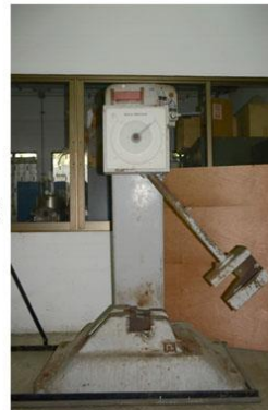
รูปที่ 3. 29 การทดสอบการกระแทก หมายเลข 1 ติดตั้งชิ้นงานในตำแหน่งที่จะกระแทก หมายเลข 2 ติดตั้งค้อนในตำแหน่งที่จะปล่อย หมายเลข 3 ปล่อยค้อนกระแทกชิ้นงาน
