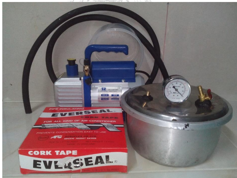
รูปที่ 3. 6 อุปกรณ์งานสุญญากาศ
