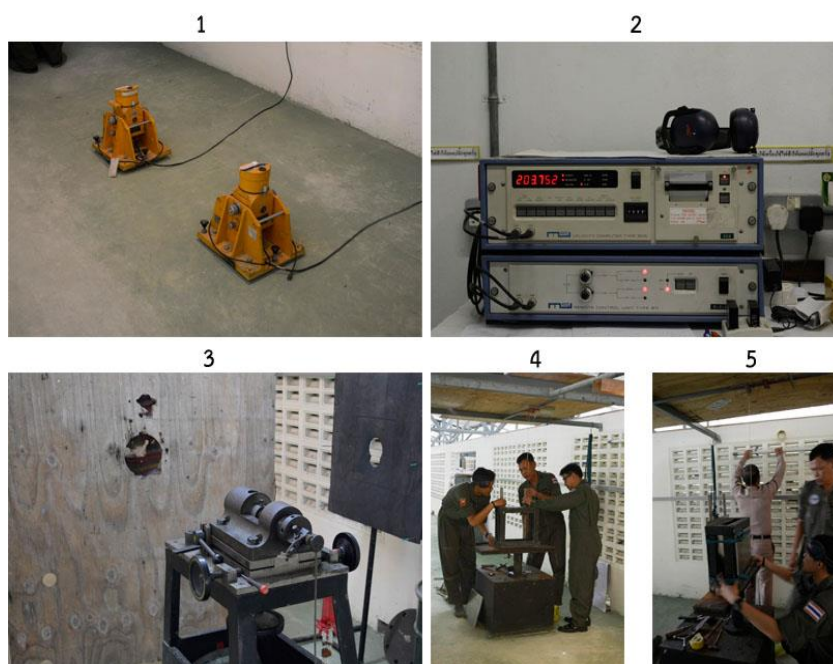
รูปที่ 3. 9 เครื่องมือทดสอบการป้องกันกระสุนวัสดุโรงงานวัตถุระเบิดทหาร
