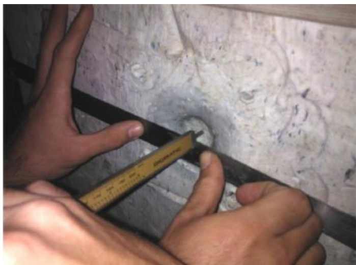
รูปที่ 2. 21 การตรวจสอบระยะลึกของการเจาะทะลุที่ Clay witness [25]
