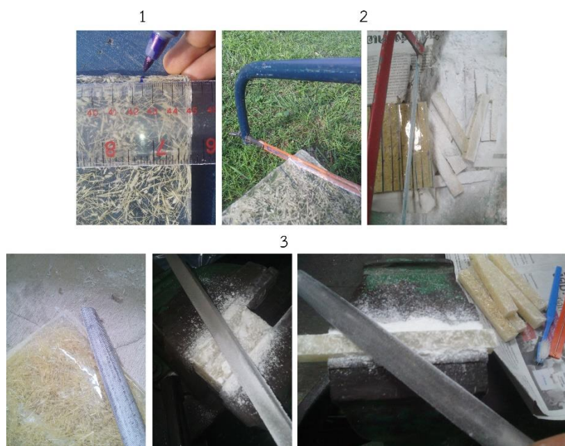
รูปที่ 3. 16 การเตรียมชิ้นงานเพื่อทดสอบหมายเลข 1 วัดขนาด หมายเลข 2 เลื่อยตัดตามที่วัดขนาด และหมายเลข 3 ตะโปให้ผิวชิ้นงานเรียบสม่ำเสมอ
