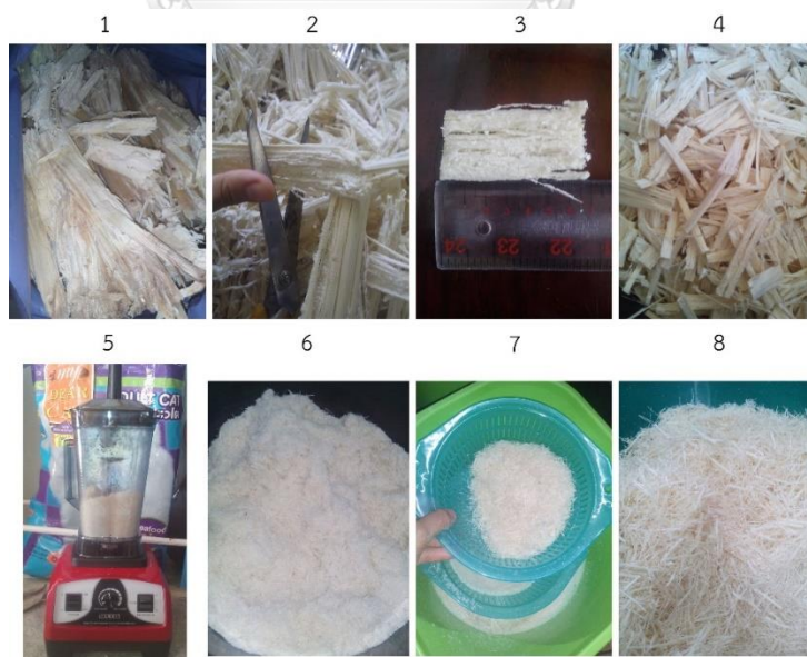
รูปที่ 3. 11 ลำดับการเตรียมเส้นใยชานอ้อยก่อนล้าง
