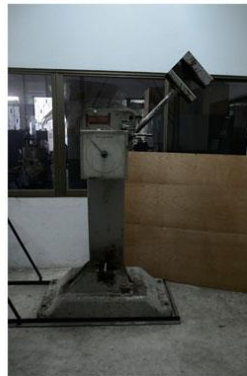
รูปที่ 3. 29 การทดสอบการกระแทก หมายเลข 1 ติดตั้งชิ้นงานในตำแหน่งที่จะกระแทก หมายเลข 2 ติดตั้งค้อนในตำแหน่งที่จะปล่อย หมายเลข 3 ปล่อยค้อนกระแทกชิ้นงาน
