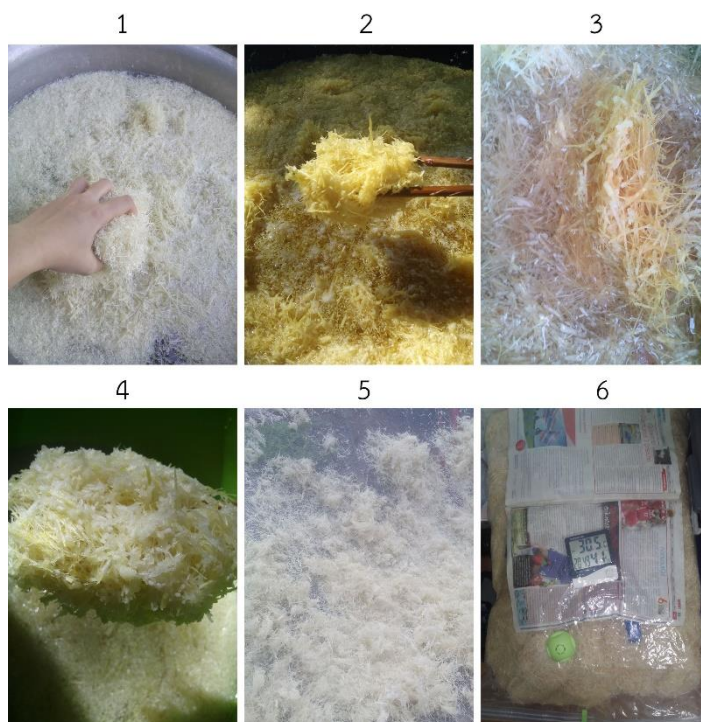
รูปที่ 3. 12 การเตรียมผิวและจัดเก็บเส้นใย
