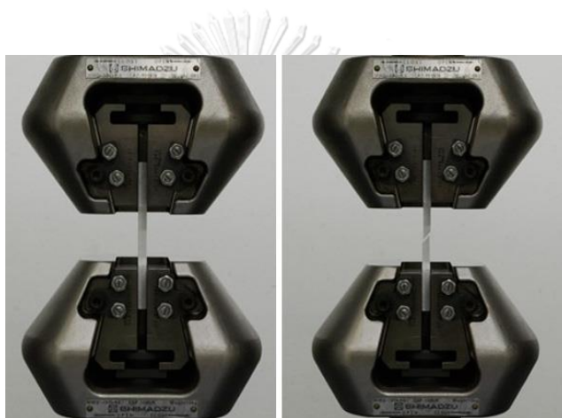
รูปที่ 4. 11 การดึงทดสอบชิ้นงานอะลูมิเนียม
