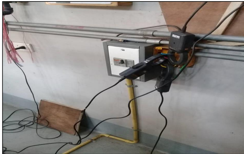
รูปที่ 3.9 การวัดพลังงานไฟฟ้าจากการใช้เครื่องบดซีเมนต์
