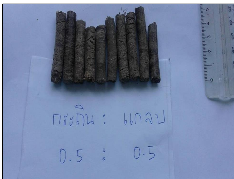
รูปที่ 2.2 ตัวอย่างชีวมวลอัดเม็ดจากกระถิน 50% : แกลบ 50%
