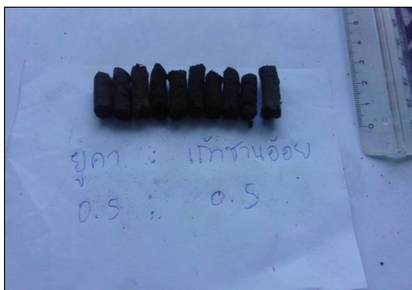
รูปที่ 2.6 ตัวอย่างชีวมวลอัดเม็ดจากยูกาลิปตัส 50% : เก้าชานอ้อย 50%
