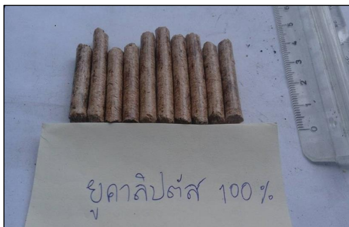
รูปที่ 1.2 ตัวอย่างชีวมวลอัดเม็ดจากยูคาลิปตัส 100%
