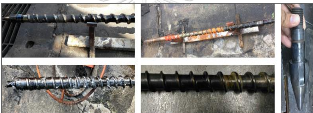
รูปที่ 5.2 ตัวอย่างสกรูที่ถอดออกมาก่อนขัดทำความสะอาด
