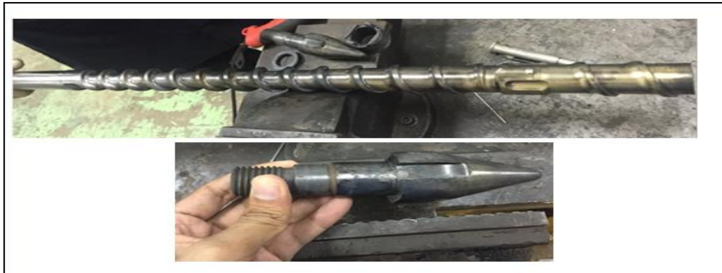
รูปที่ 4.10 ตัวอย่างสกรูสกรอกปรกที่ไม่ได้ขัดทำความสะอาด
