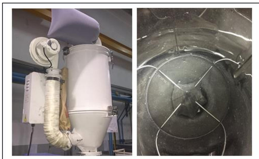
รูปที่ 4.13 ตัวอย่างเครื่องอบเม็ดพลาสติกและเศษพลาสติกที่คงค้าง
