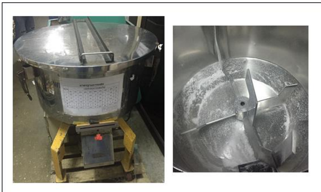
รูปที่ 4.14 ถังผสมเม็ดพลาสติกและตัวอย่างเศษเม็ดพลาสติกที่คงค้าง
