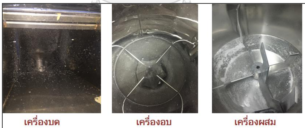
รูปที่ 6.10 ตัวอย่างเศษพลาสติกที่อาจมีการปนเปื้อนในกระบวนการถัดไป
