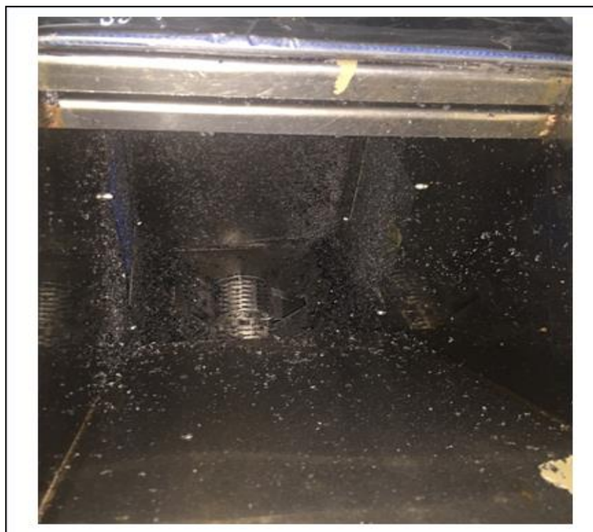
รูปที่ 4.12 เศษของเม็ดพลาสติกที่เกิดขึ้นหลังการบด
