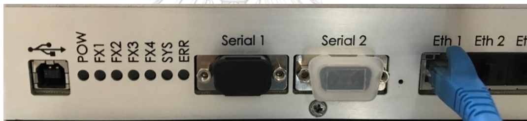
รูปที่ 3-13 ทดสอบปิดแหล่งจ่ายไฟอุปกรณ์ลัดสัญญาณแสงของอุปกรณ์ FRTU จำลองชุดที่ 1 (ไฟสถานะ Power ดับ) พบว่าอุปกรณ์ FRTU จำลองชุดที่ 1 ไม่สามารถติดต่อกับ DMS Master Station จำลอง (ต่อ)
