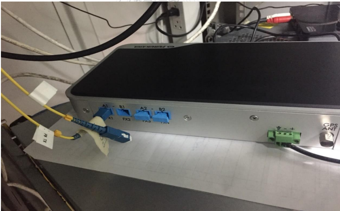
รูปที่ 3-34 จำลองเส้นใยแก้วนำแสงชำรุด 1 เส้นทาง โดยปลดเส้นใยแก้วนำแสงที่เชื่อมต่อระหว่างอุปกรณ์ลัดสัญญาณแสงที่อุปกรณ์ FRTU ชุดที่ 2
