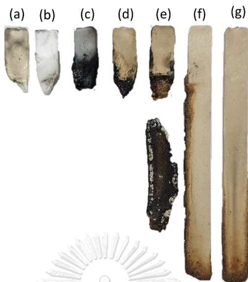
รูปที่ 4.17 ชิ้นทดสอบหลังการทดสอบ UL-94 ของ (a) PLA, (b) HIPS, 80/20 PLA/HIPS คอมพอสิตที่มีอัตราส่วน WF/MH เท่ากับ (c) 0/0 (d) 20/0, (e) 20/20, (f) 20/30, และ (g) 20/40
