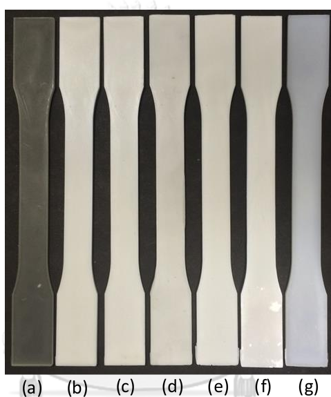
รูปที่ 4.1 ชิ้นทดสอบของ (a) PLA, (b) HIPS และพอลิเมอร์ผสม PLA/HIPS ที่อัตราส่วน (w/w) (c) 90/10, (d) 80/20, (e) 70/30, (f) 60/40 และ (g) 50/50
