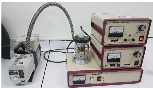
รูปที่ 3.15 เคลือบทองในระบบสุญญากาศบนพื้นผิว
