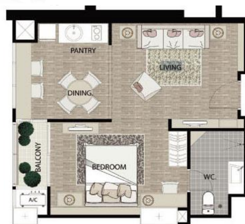
รูปภาพ 46 ผังห้องชุดพักอาศัยขนาด 45.5 ตารางเมตร โครงการ Rhythm รัชดา
