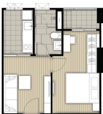
ผังห้องชุดพักอาศัยขนาด 34 ตารางเมตร โครงการ ไอดีโอ ท่าพระ interchange
