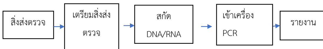
รูปที่ 8 แสดงขั้นตอนการทำงานห้องปฏิบัติการ Chula MRC
