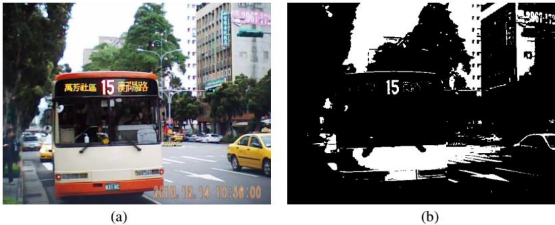
รูปที่ 2.26 ระบบตรวจจับเลขสายรถประจำทางจากภาพถ่ายวิดีโอ (a) ภาพลำดับนำเข้า (b) ภาพไบนารี [34]
