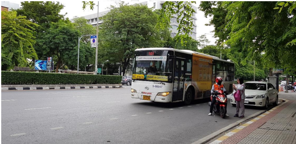
รูปที่ 2.36 รถประจำทางที่แสดงข้อมูลบริเวณแผงด้านบนของรถประจำทางแบบ หลอดไฟแอลอีดี
