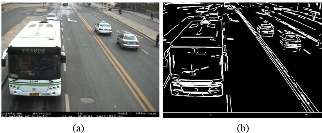
รูปที่ 2.27 ระบบตรวจจับและรู้จำรถประจำทาง (a) ภาพลำดับนำเข้า (b) ภาพจากวิธีการ LSD [35]
