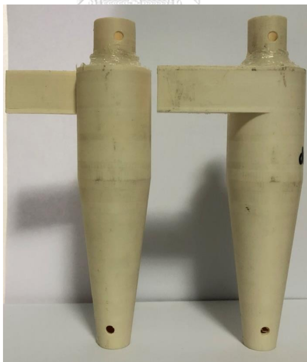
รูปที่ 4.26 ไซโคลนต้นแบบจากเทคโนโลยีการพิมพ์สามมิติ (ซ้าย) ไซโคลนสแตมาน (ขวา) ไซโคลนที่ลดขนาดเส้นผ่านศูนย์กลางทางออกของแก๊ส 10%
