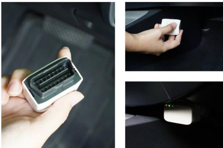
รูปที่ 21 ตัวอย่างการติดตั้ง OBD ที่รถของอาสาสมัคร [37]
