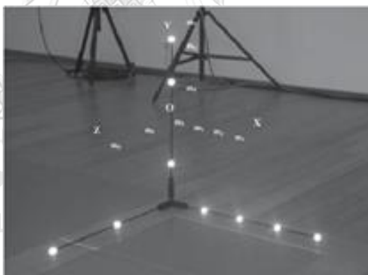
รูปที่ 10 ขาดั้งสามฉาก (Three Orthogonal Wands) (Pribanic et al., 2009)
