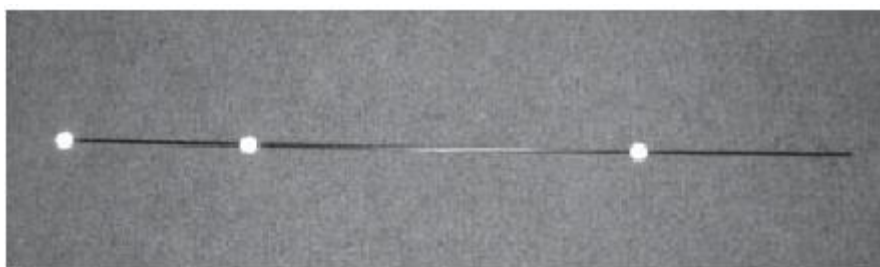
รูปที่ 11 ไม้คาลิเบรท แบบมาร์กเกอร์ 3 ตัว (Calibration Wands) (Pribanic et al., 2009)
