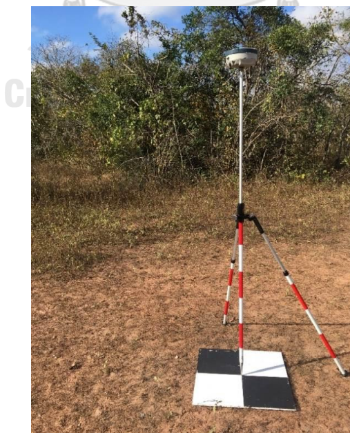
รูปที่ 4.3 การสำรวจรังวัดจุดควบคุมและจุดตรวจสอบ
