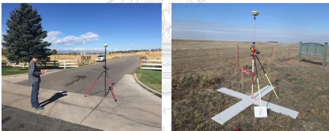
รูปที่ 2.5 แสดงตำแหน่งจุดควบคุมและจุดตรวจสอบที่เหมาะสม
