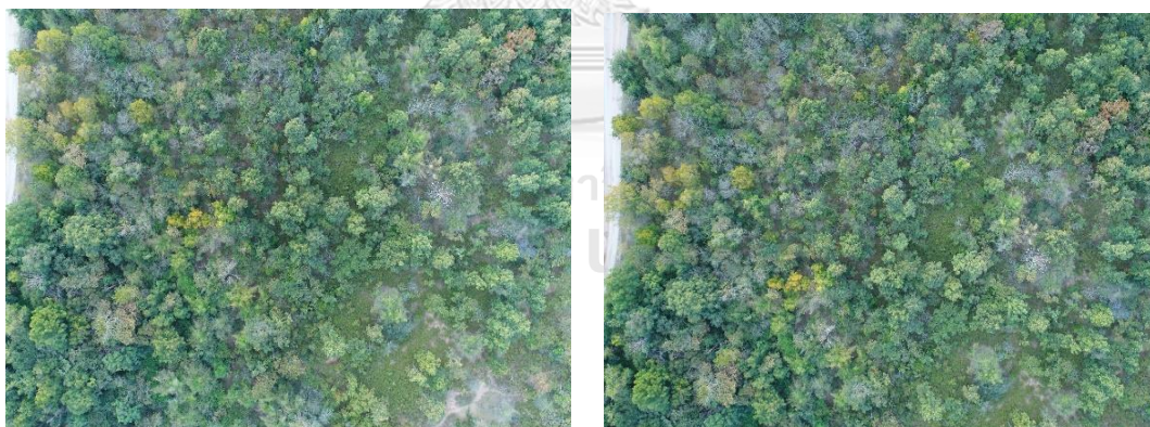
รูปที่ 5.1 ภาพถ่ายทางอากาศที่ได้จากบินสำรวจด้วยอากาศยานไร้คนขับที่มีส่วนซ้อน (Overlap) ร้อยละ 85 และส่วนเกย (Sidelap) ร้อยละ 70
