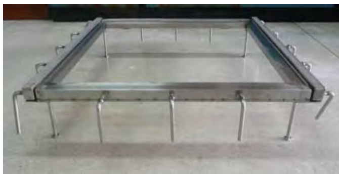
รูปที่ 3.1 กรอบโลหะไร้สนิม ขนาด 2 ฟุต × 2 ฟุต
