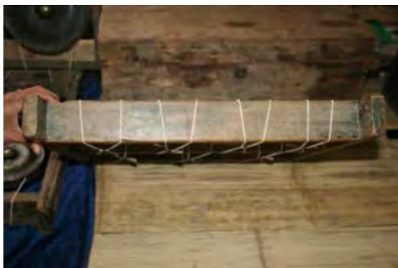
ภาพที่ ๖๐ (ซ้าย) มองแว็งผูกติดกับกรอบไม้ด้วยเชือกฝ้ายหรือเชือกไนลอน
