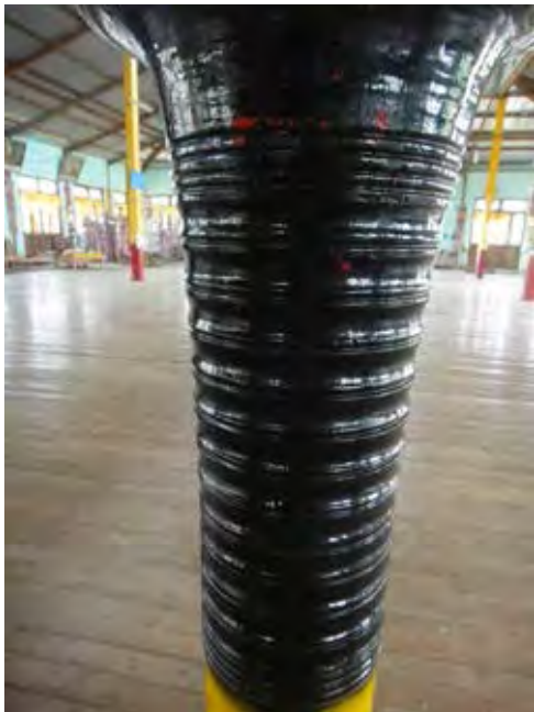
ภาพที่ ๓๓๒ การบากควั่นลูกแก้วจากฐานไหกลองถึงเอวกลอง
