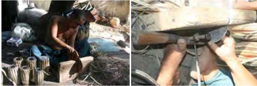
ภาพที่ ๓๑ (ซ้าย-ขวา) การใช้นางข่งตัดหนังเรียด
