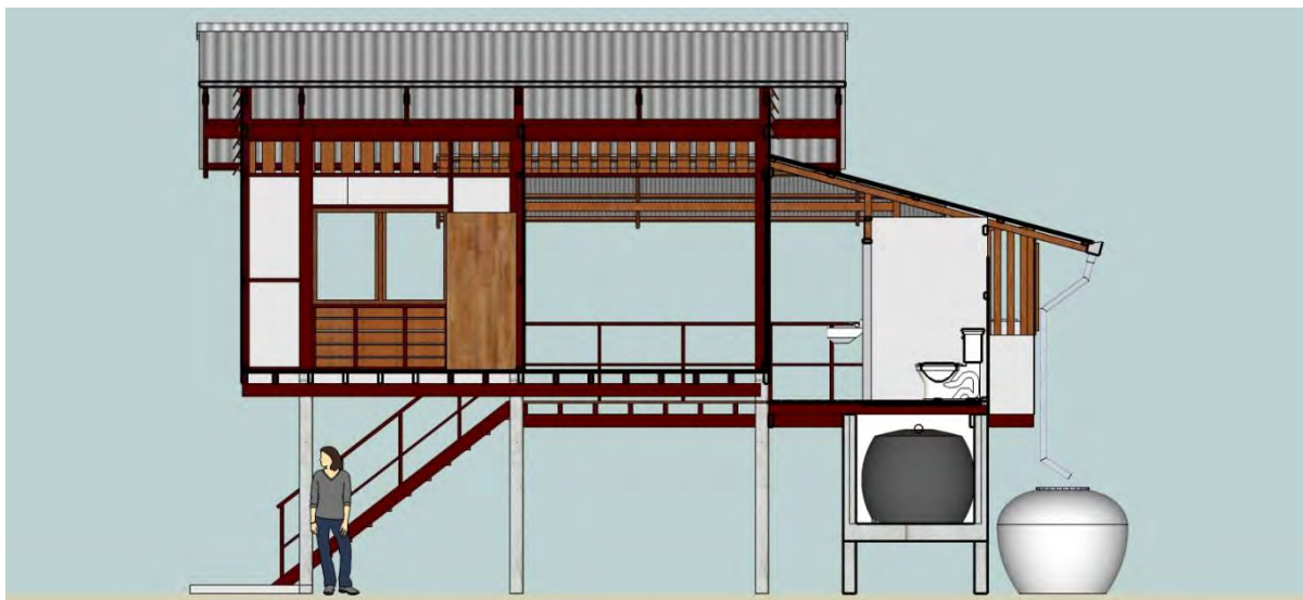
ภาพที่ 78 รูปตัด บ้านต้นแบบ บ้านเรือนวิถีไท
