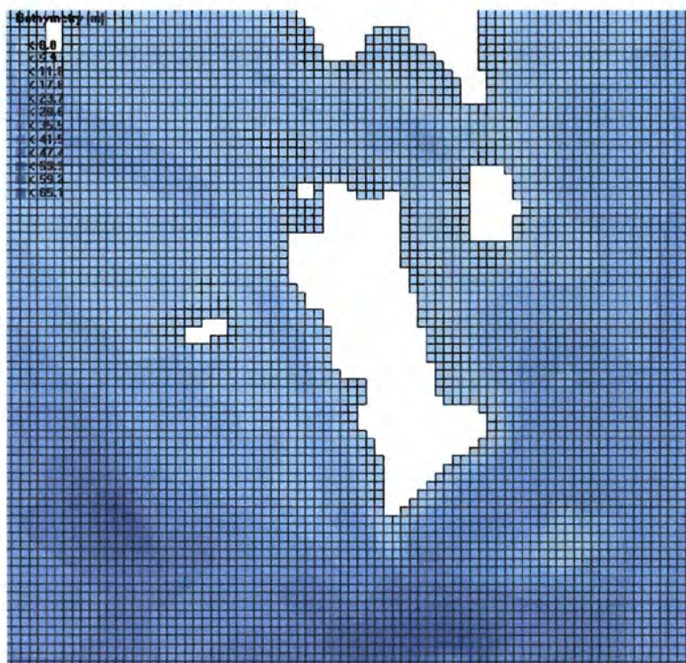
รูปที่ 3 กริดของแบบจำลอง Delft3D-FLOW สำหรับพื้นที่รอบเกาะเสมสาร
