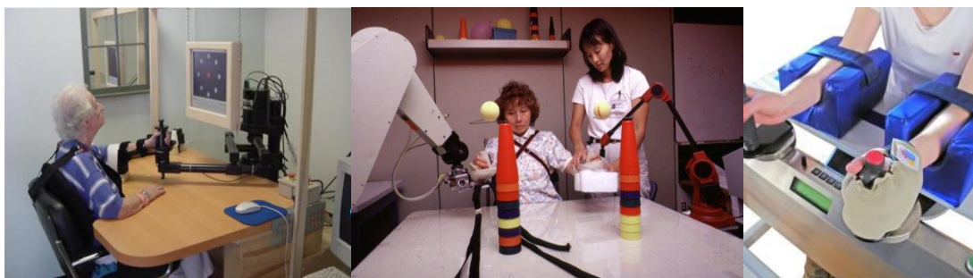
รูปที่ 1.2 หุ่นยนต์สำหรับทำกายภาพบำบัดประเภท End-Effector-Based Type (MIT MANUS, MIME และ Bi-Manu-Track)
