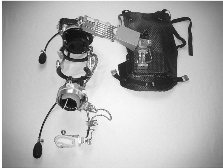
รูปที่ 2.7 หุ่นยนต์สวมแขน 15 องศาอิสระ [5]
