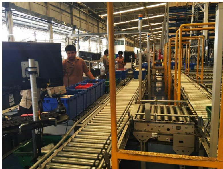
รูปที่ 4.11 การเกิด Blocking ของตะกร้าสินค้าเบ็ดเตล็ดบนระบบจัดเก็บและเรียกคืนวัสดุอัตโนมัติ
