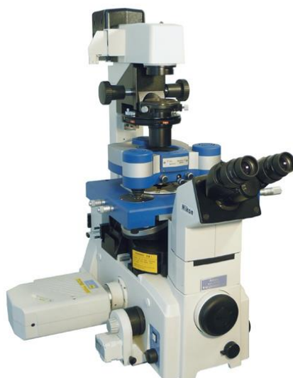
รูปที่ 2.14 ภาพถ่ายภายนอกของกล้องจุลทรรศน์แรงอะตอมรุ่น Bio-AFM ของบริษัท JPK Instruments
