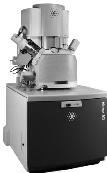
รูปที่ 2.7 ภาพถ่ายภายนอกของกล้องจุลทรรศน์อิเล็กตรอนแบบส่องกราด (FE-SEM) รุ่น versa 3D ของบริษัท FEI
