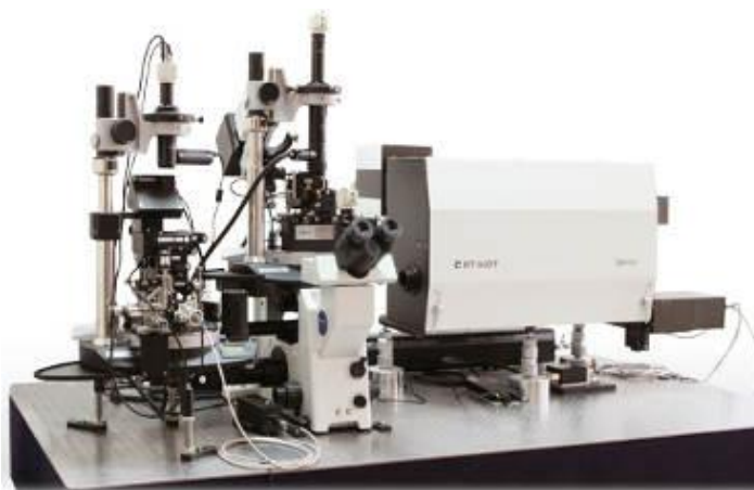
รูปที่ 2.25 แสดงภาพเครื่องรามานสเปกโทรมิเตอร์ (Raman spectrometer) รุ่น NTEGRA-spectra บริษัท NT-MDT
