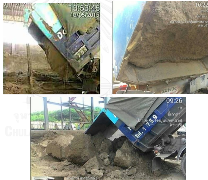
ภาพที่ 4.2 การจับตัวเป็นก้อนแข็งขนาดใหญ่ของเถ้าที่มีปริมาณแคลเซียมออกไซด์และสัมพัทธ์ความชื้น และจับตัวเป็นก้อนแข็งติดกระบะรถบรรทุก
