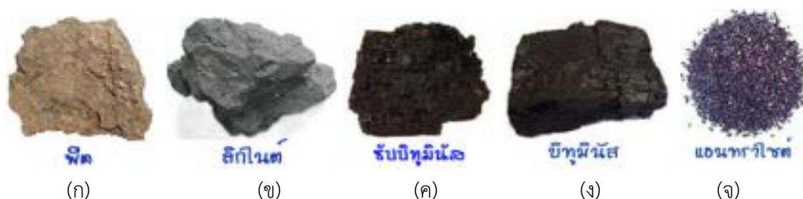
ภาพที่ 2.1 ถ่านหินลำดับชั้นต่าง ๆ (ก) พีต, (ข) ลิกไนต์, (ค) ซัฟไฟต์, (ง) บิทูมินัส, (จ) แอนทราไซต์ [3]
