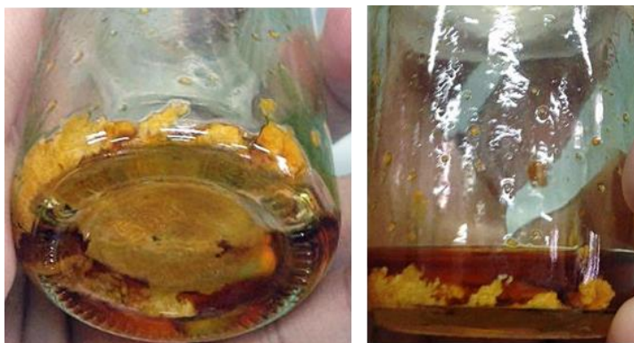
ภาพที่ 4.15 สารละลายตั้งต้น Pt-TiO 2 /กราฟีน (สารแขวนลอยกราฟีนออกไซด์) ก่อนนำไปบ่ม
