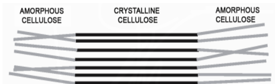
ภาพที่ 2.3 บริเวณส่วนที่เป็นผลึกและบริเวณที่เป็นอสัณฐานของเซลลูโลส [13]
