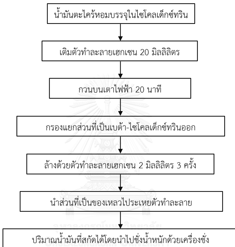
รูปที่ 3.5 ขั้นตอนการหาปริมาณน้ำมันตะไคร้หอมที่ผิวเบต้า-ไซโคลเดกซ์ทริน
