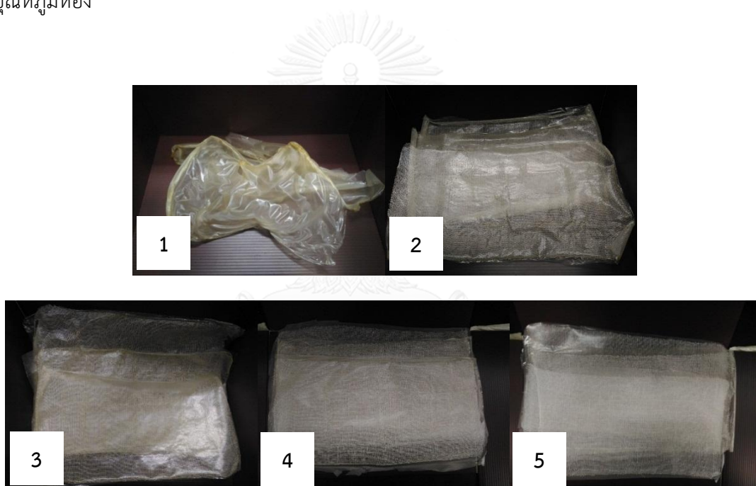
รูปที่ 4.3 ลักษณะปรากฏของฟิล์มไคโตซาน (1), แผ่นไคโตซาน/ผ้าฝ้ายก๊อช (2) และแผ่นไคโตซาน/ผ้าฝ้ายก๊อชที่มีน้ำมันตะไคร้หอมบรรจุในเบต้า-ไซโคลเด็กซ์ทรีนปริมาณร้อยละ 5 (3), 10 (4) และ 15 (5) ของน้ำหนักไคโตซาน
