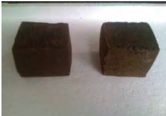
ภาพที่ 4.7 แสดงลักษณะรูปทรงลูกบาศก์หลังจากถอดแบบของอัตราส่วนเสียซิลิกาและอะลูมินา บริสุทธิ์ ที่ 40:20 และ 47:23 (ก) อัตราส่วน A1 (60:20:20) และ (ข) อัตราส่วน B2 (70:10:20)
