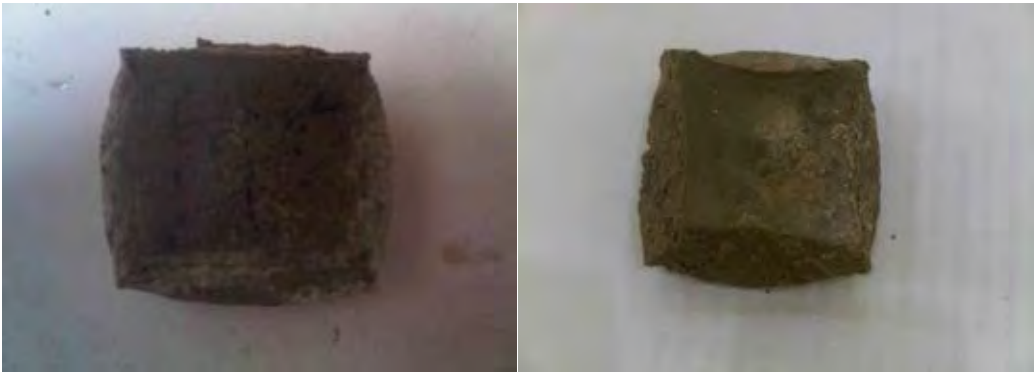
ภาพที่ 4.6 แสดงลักษณะผิตรูปทรงลูกบาศก์หลังจากถอดแบบของอัตราส่วนเสียซิลิกาและอะลูมินา บริสุทธิ์ ที่ 45:15 และ 53:17 (ก) อัตราส่วน A1 (60:20:20) และ (ข) อัตราส่วน B2 (70:20:10)
