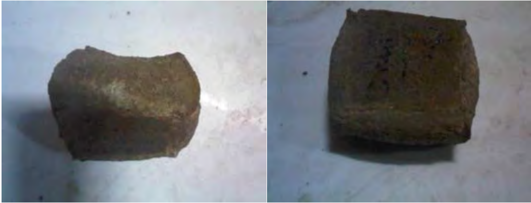
ภาพที่ 4.5 แสดงลักษณะผิตรูปทรงลูกบาศก์หลังจากถอดแบบของอัตราส่วนเสียซิลิกาและอะลูมินา บริสุทธิ์ ที่ 30:30 และ 35:35 (ก) อัตราส่วน A1 (60:20:20) และ (ข) อัตราส่วน B2 (70:10:20)
