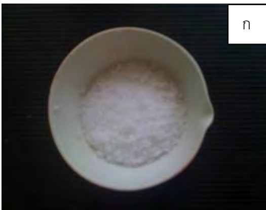
ภาพที่ 3.3 (ก) อะลูมินาบริสุทธิ์ และ (ข) โครงสร้างของอะลูมินาบริสุทธิ์ ( Al_2O_3 )
