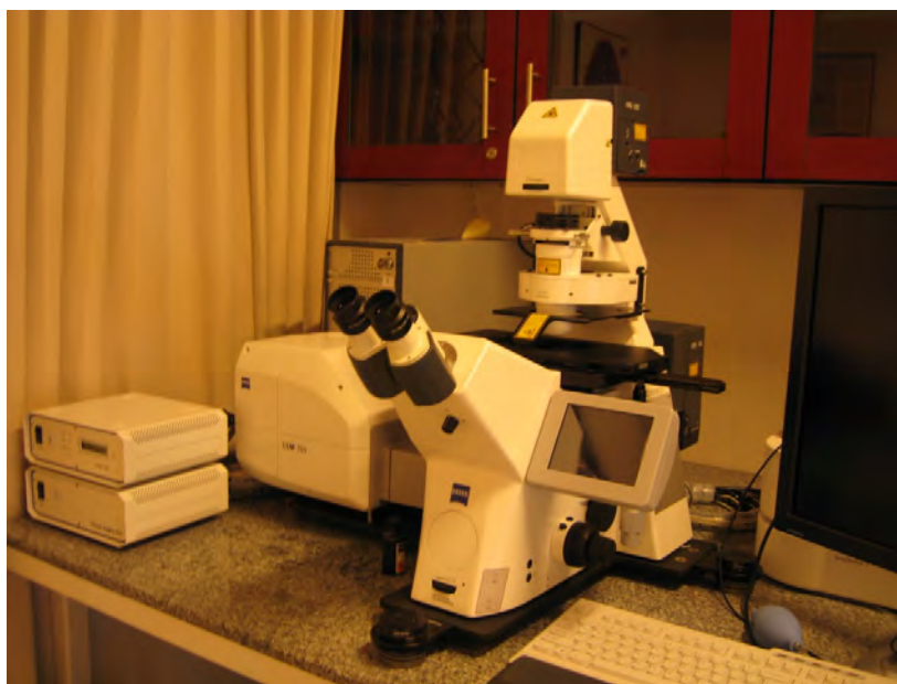
ภาพที่ 3.10 Confocal microscope (Laser scanning microscope) ที่ใช้ในการศึกษาวิจัยครั้งนี้
