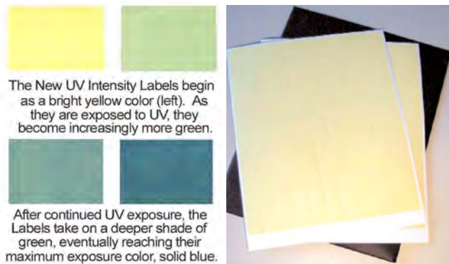
ภาพที่ 2-16 ภาพแสดงผลลักษณะฉลากทดสอบความเข้มของรังสีอัลตราไวโอเล็ต (UV INTENSITY LABELS)
