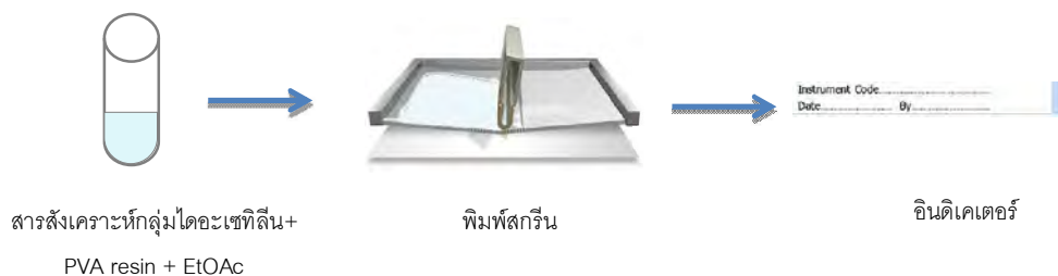
ดั่งภาพที่ 4-11 แสดงขั้นตอนการเตรียมอินดิเคเตอร์จากสารกลุ่มไดอะเซทิลีน
