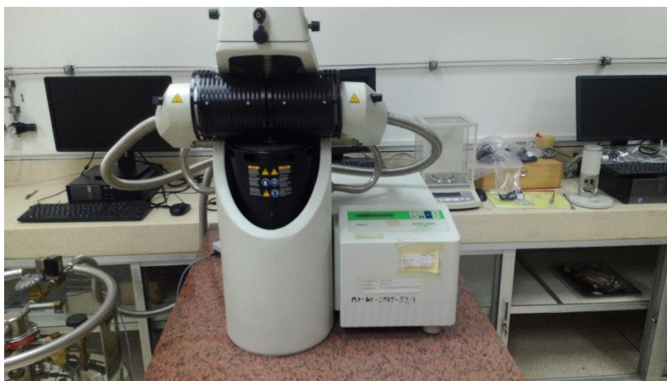
รูปที่ 3.11 เครื่องวิเคราะห์สมบัติเชิงกลพลวัต
