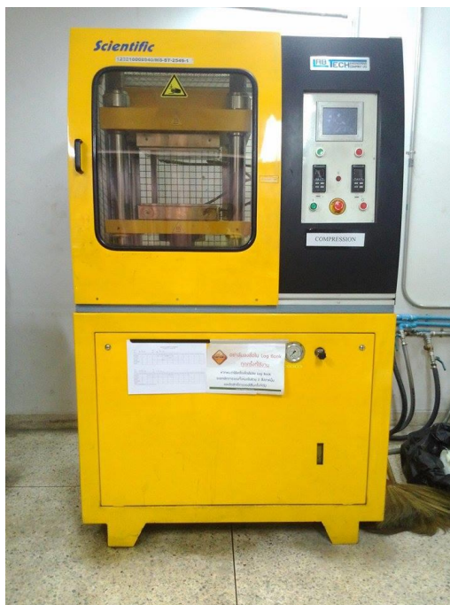
รูปที่ 3.7 เครื่องอัดแบบ
