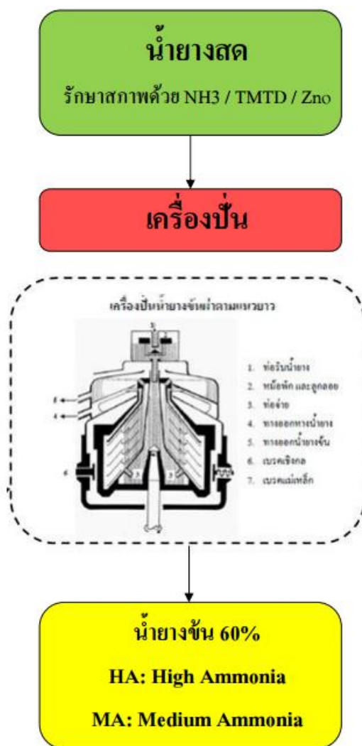
รูปที่ 2.2 การผลิตน้ำยางชั้นชนิด 60% [5]
