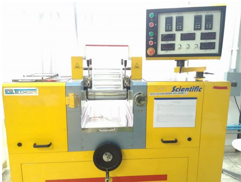
รูปที่ 3.4 เครื่องบดแบบ 2 ลูกกลิ้ง
