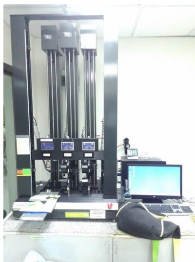
รูปที่ 3.8 เครื่องทดสอบสมบัติความทนแรงดึงและความทนแรงฉีกขาด
