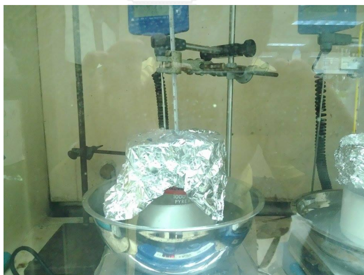
รูปที่ 3.1 เครื่องมือที่ใช้ในการเตรียมยางธรรมชาติอีพอกซิไดซ์
