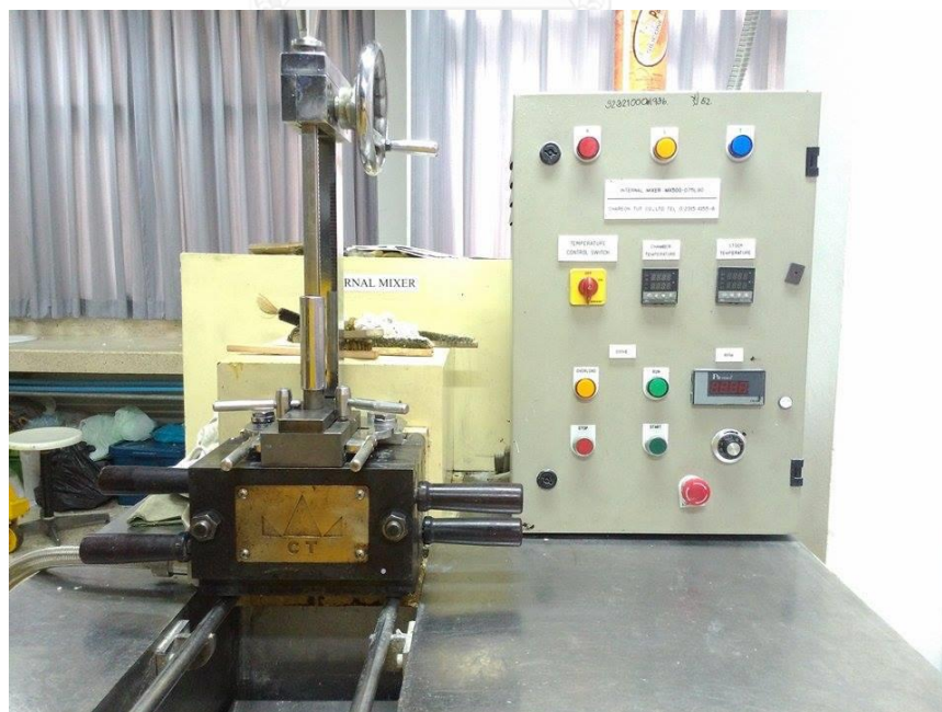
รูปที่ 3.3 เครื่องบดผสมแบบปิด
