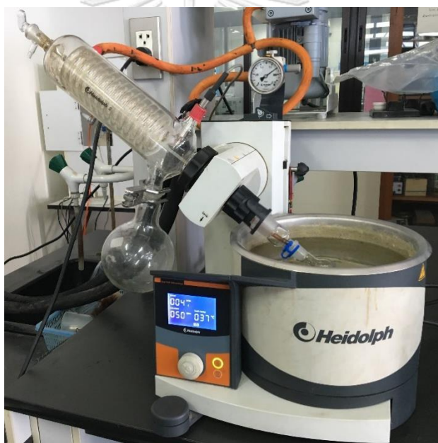
รูปที่ 3.14 เครื่อง Rotary evaporator ยี่ห้อ Heidolph Hei Vap
