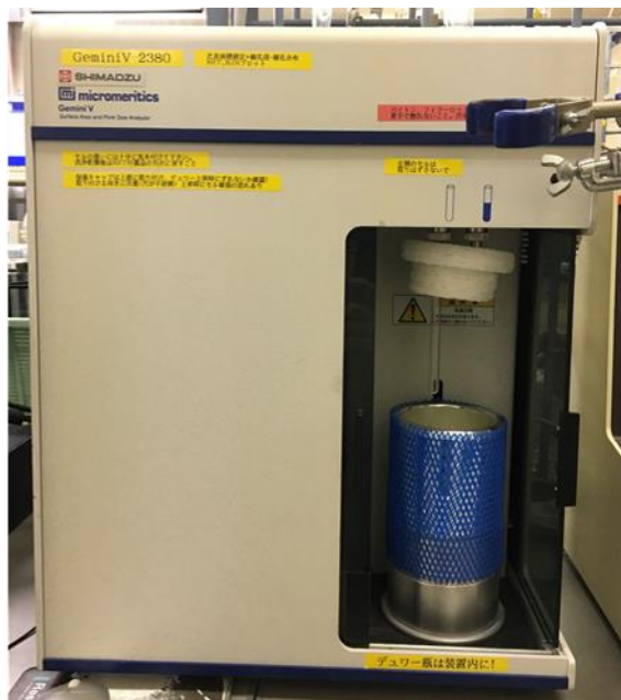
รูปที่ 3.12 เครื่องวัดพื้นที่ผิวเยื่อ Gemini V 2380
