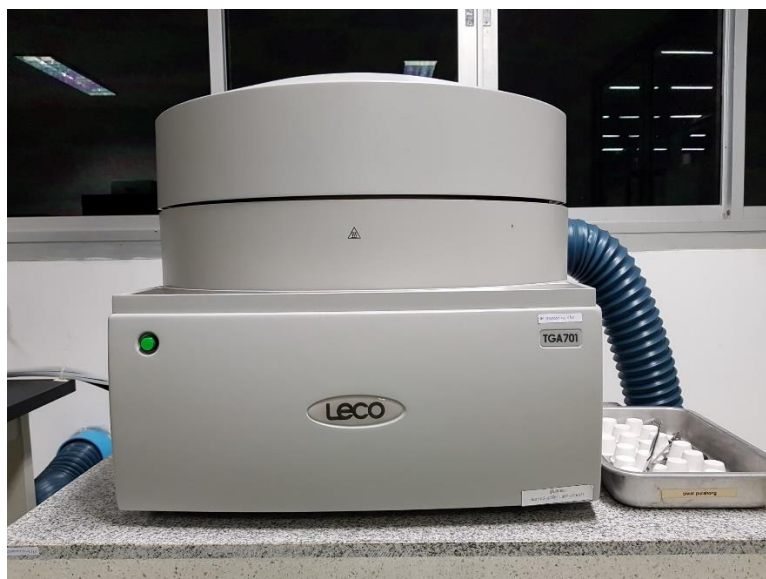
รูปที่ 3.9 เครื่องวิเคราะห์การสลายตัวทางความร้อน
