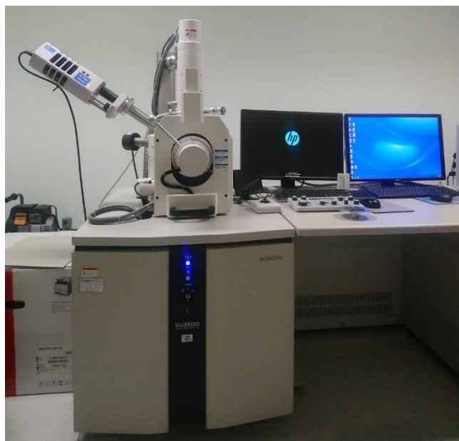
รูปที่ 3.17 กล้องจุลทรรศน์อิเล็กตรอนแบบส่องกราด (SEM)
