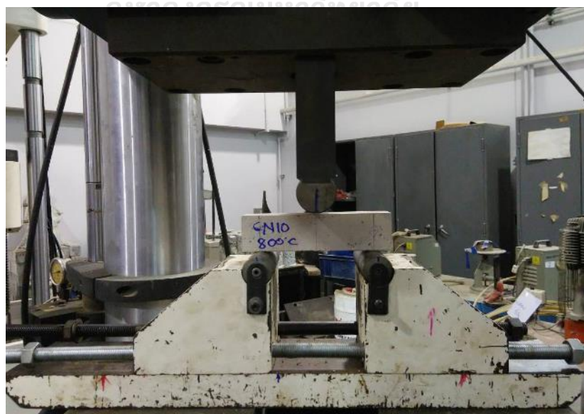
รูปที่ 3.16 มาตรฐานการทดสอบกำลังรับแรงดัด ASTM C239 [31]
