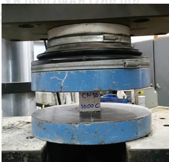
รูปที่ 3.14 การทดสอบกำลังรับแรงอัด ASTM C109 [30]
