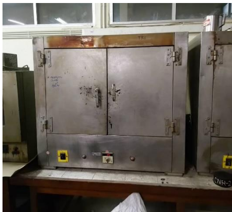
รูปที่ 3.9 เครื่องอบมอร์ตาร์ก่อนการทดสอบ 1 วัน
