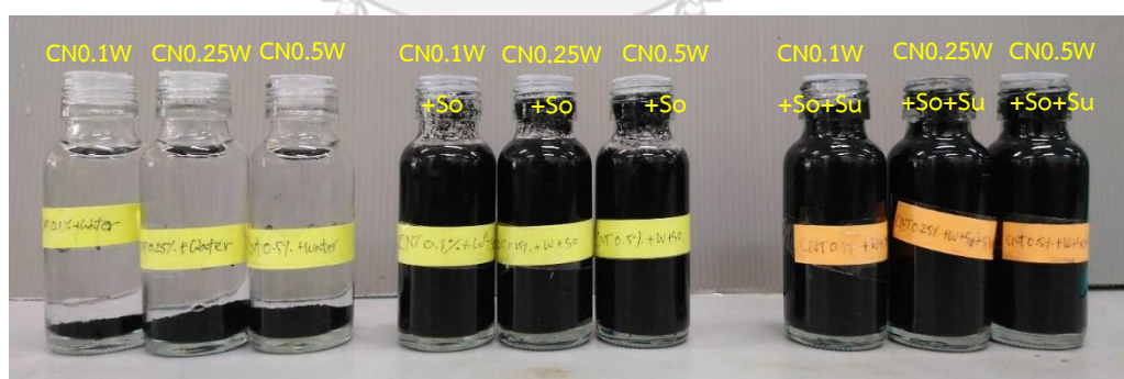
รูปที่ ก.2 การตกตะกอนของท่อนาโนคาร์บอนเมื่อเวลาผ่านไป 7 วัน
